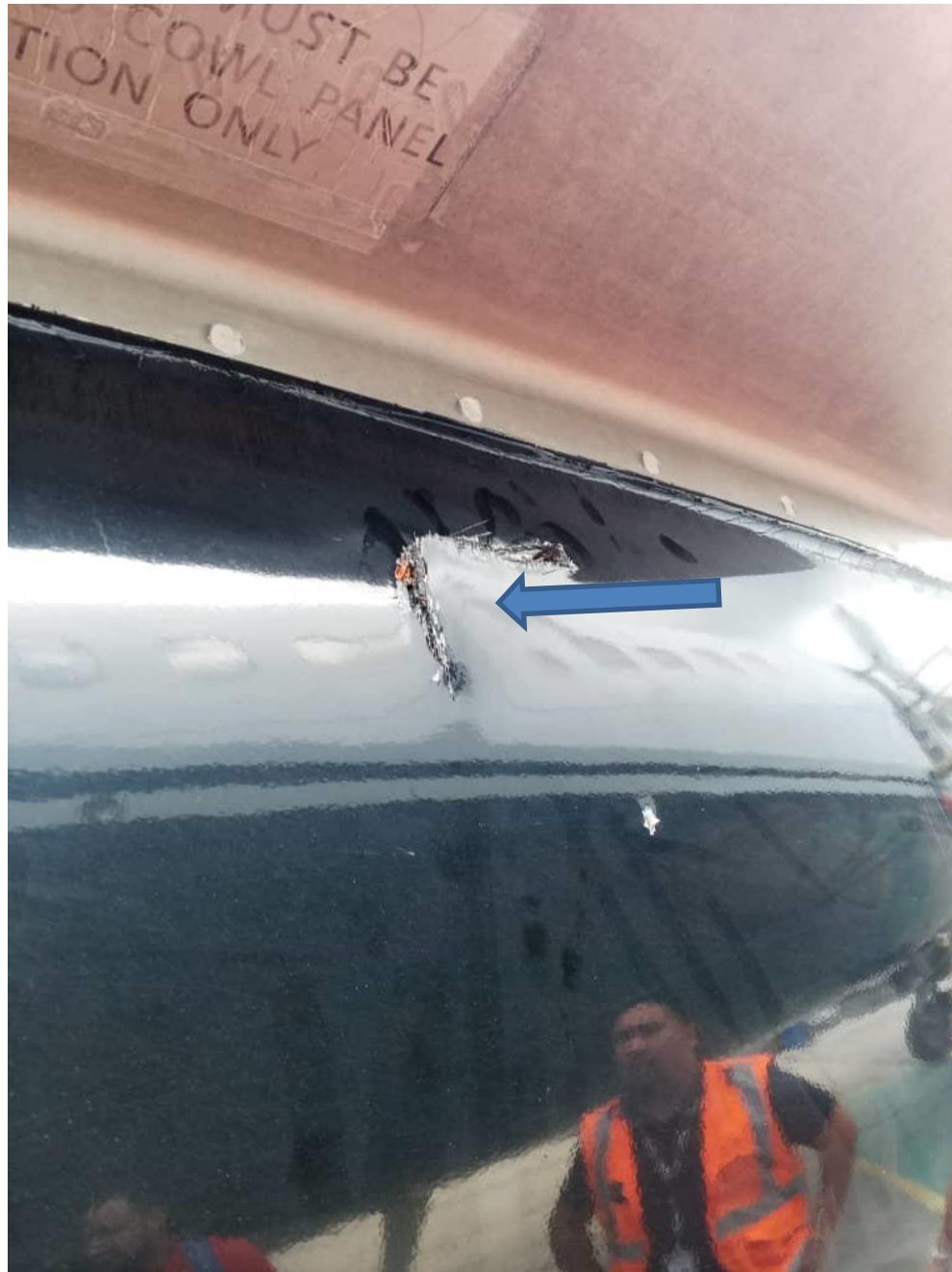
Figura 6. Fractura del Fan Cowl Derecho Daño (Capota) YV666T Fuente: Investigador Encargado. Año: 2025
