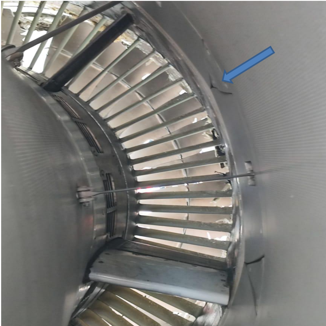
Figura 2. Daños en los álabes YV666T Fuente: Investigador Encargado. Año: 2025
