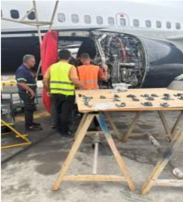
Figura 8. Alabes afectados motor Derecho YV666T. Fuente: Investigador Encargado. Año: 2025
