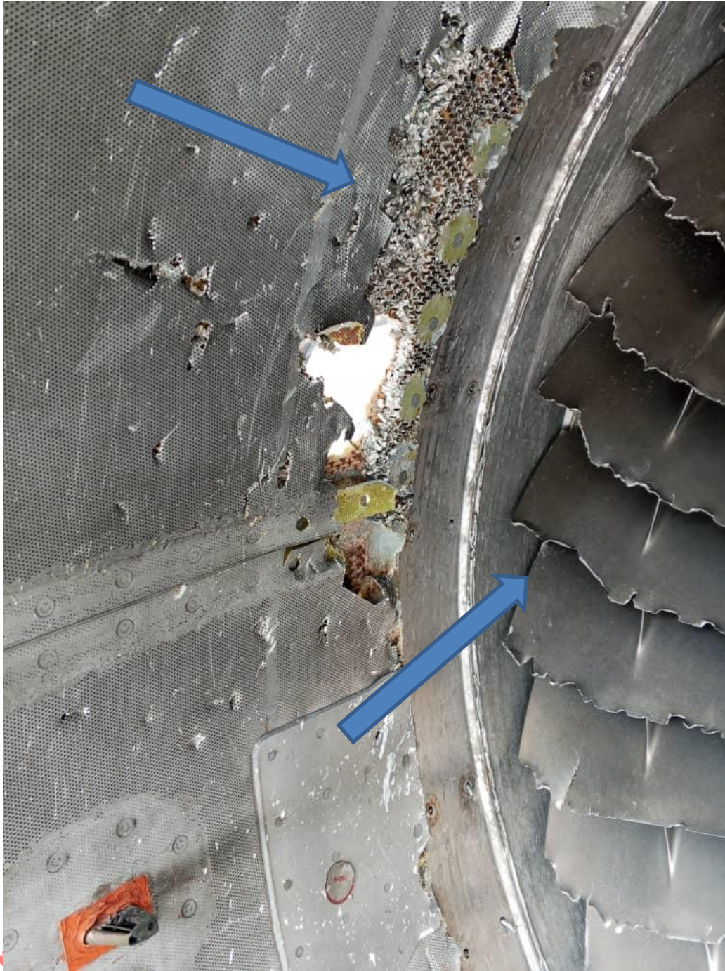
Figura 4. Ruptura de los álabes y daños en los paneles acústicos YV666T Fuente: Investigador Encargado. Año: 2025
