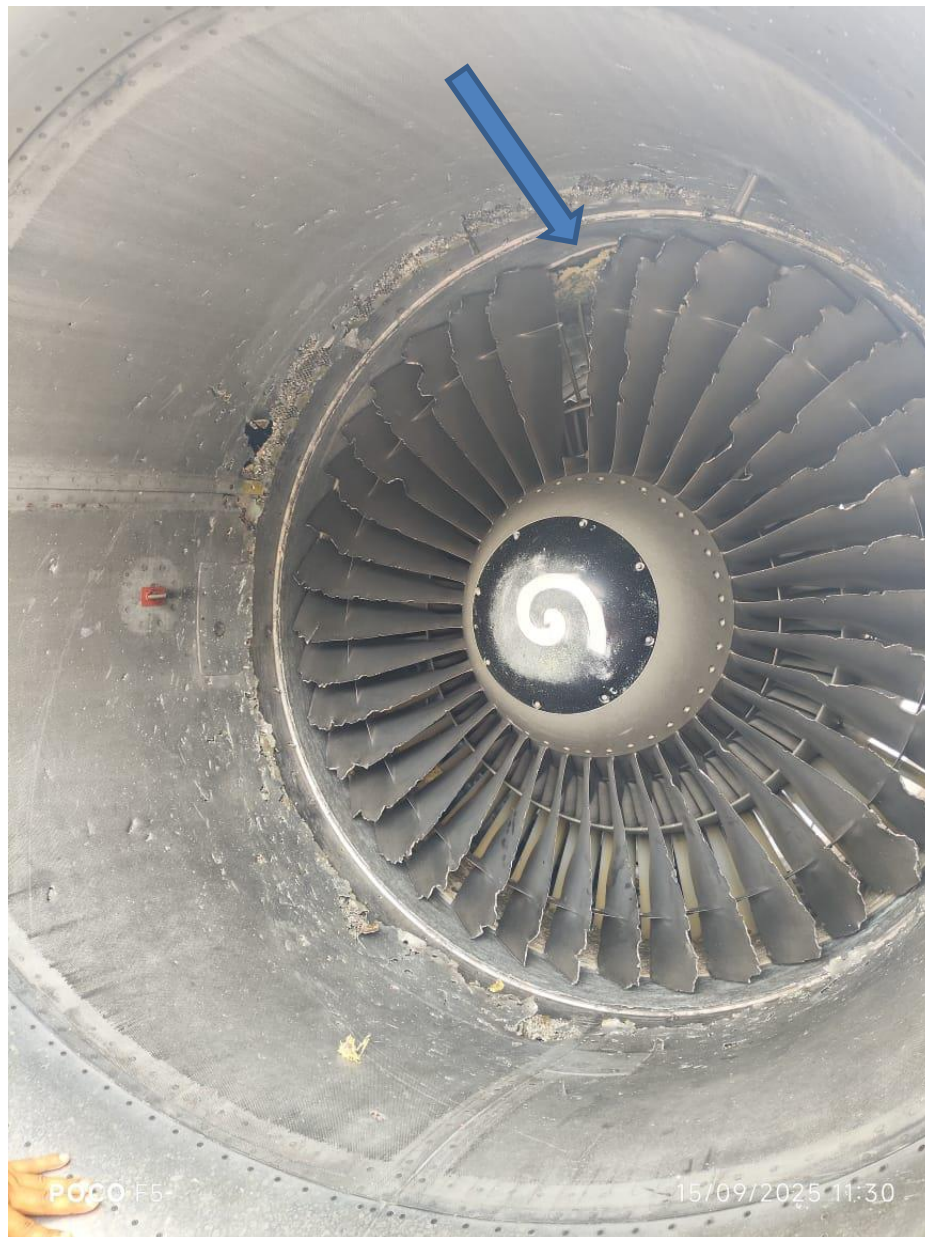
Figura 3. Fractura de los Álabes YV666T Fuente: Investigador Encargado. Año: 2025
