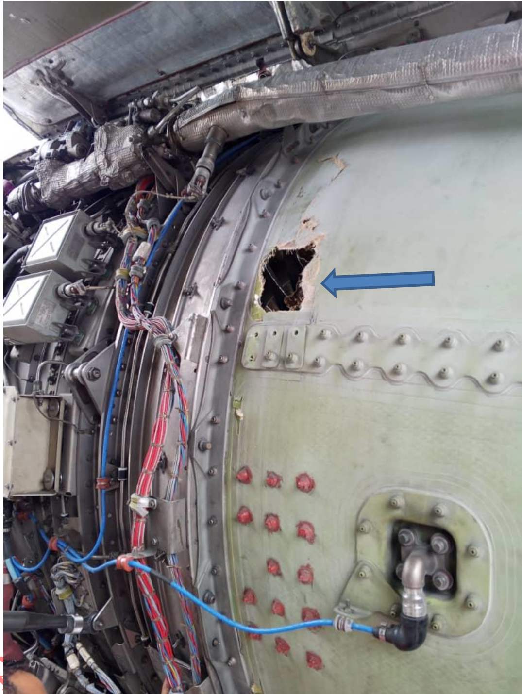
Figura 5. Perforación del Nose Cowl YV666T Fuente: Investigador Encargado. Año: 2025
