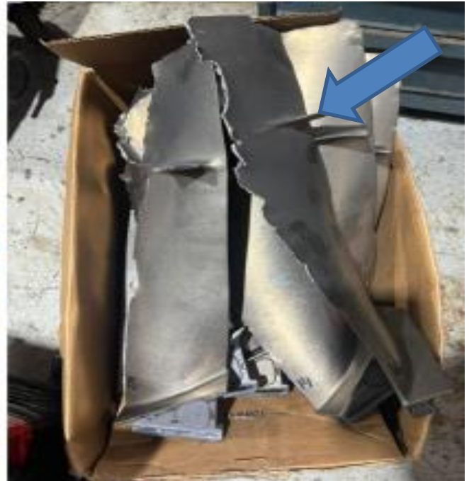
Figura 8. Alabes afectados motor Derecho YV666T. Fuente: Investigador Encargado. Año: 2025
