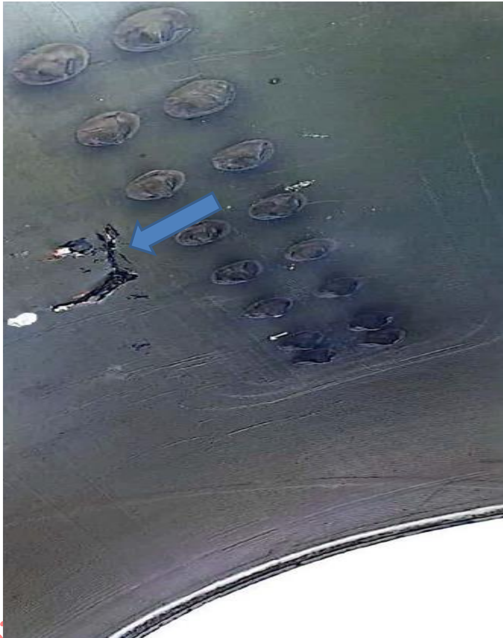
Figura 7. Fractura del Fan Cowl Derecho YV666T. Fuente: Investigador Encargado. Año: 2025
