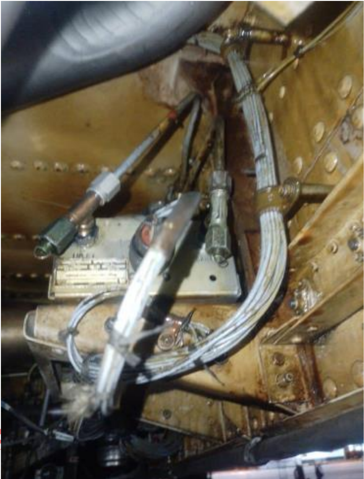
Figura 7. Inspección del Sistema de Válvulas Bleed, aeronave YV2794 Fuente: Investigador Encargado. Año: 2025
