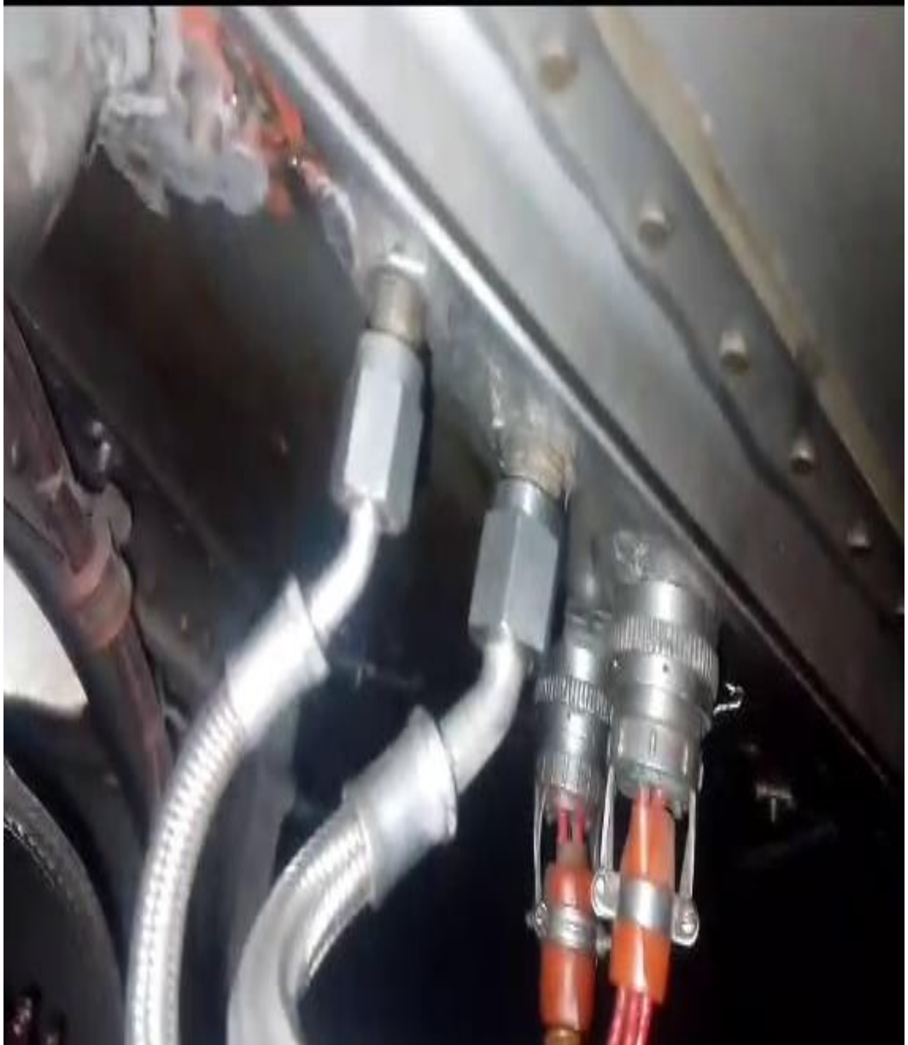
Figura 6. Lubricación de las válvulas Bleed, aeronave YV2794 Fuente: Investigador Encargado. Año: 2025
