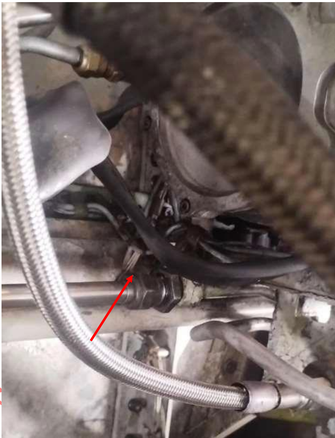
Imagen 4. Fuga Hidráulica del sistema A, aeronave YV2792
