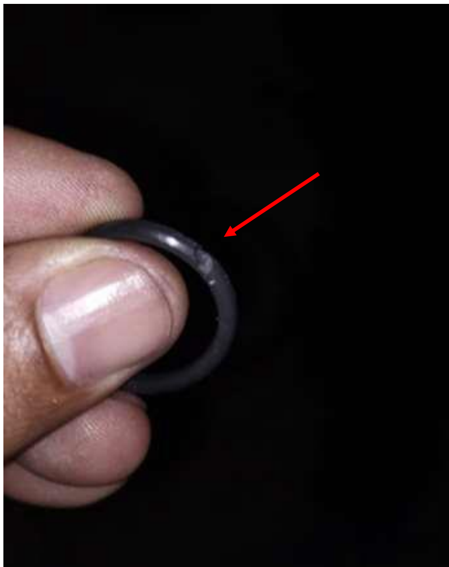
Imagen 3: PACKING O-RING del sistema B dañado, aeronave YV2792
