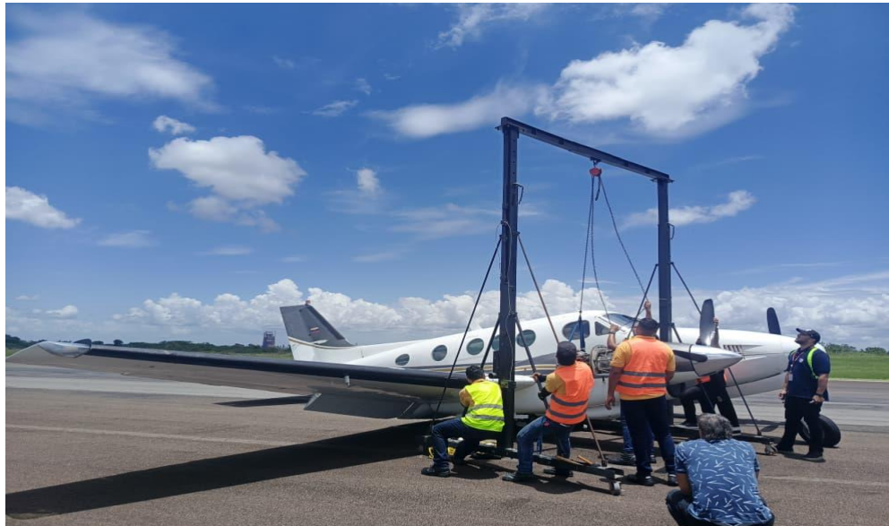
Figura 17. Trabajos para el despliegue de los trenes principales de la aeronave YV2410 Fuente: Investigador Encargado. Año: 2025
