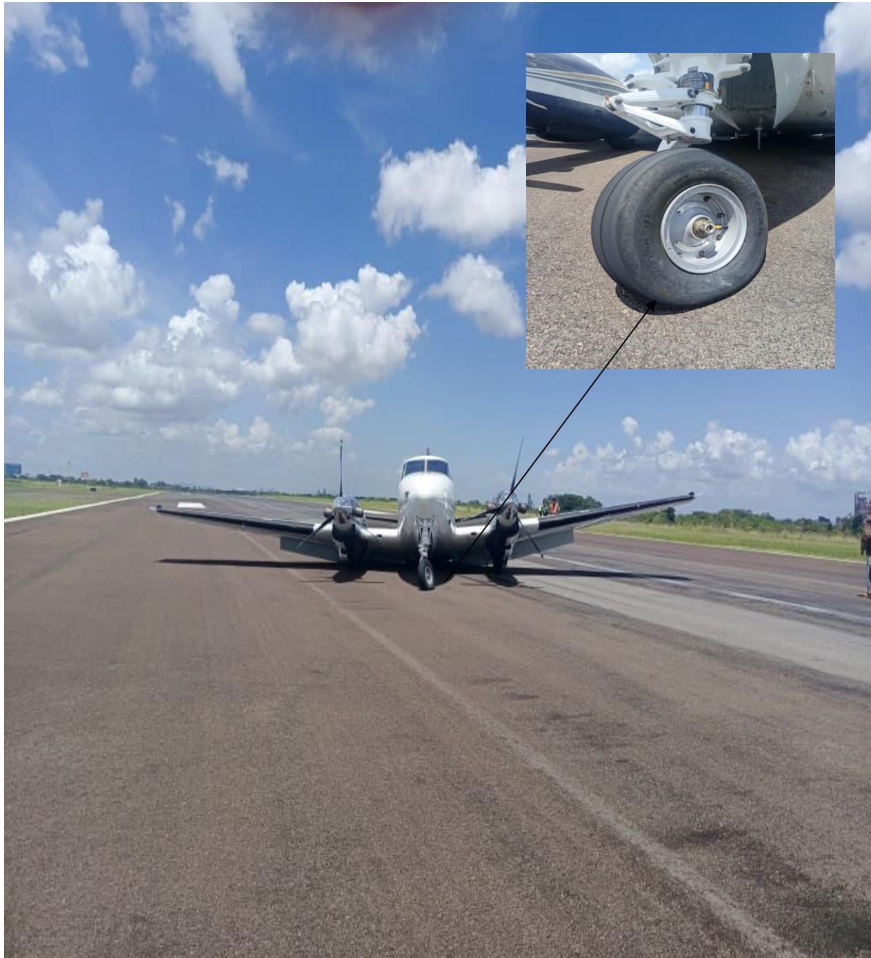
Figura 5. Tren de nariz (caucho sin presión) Aeronave YV2410 Fuente: Investigador Encargado. Año: 2025
