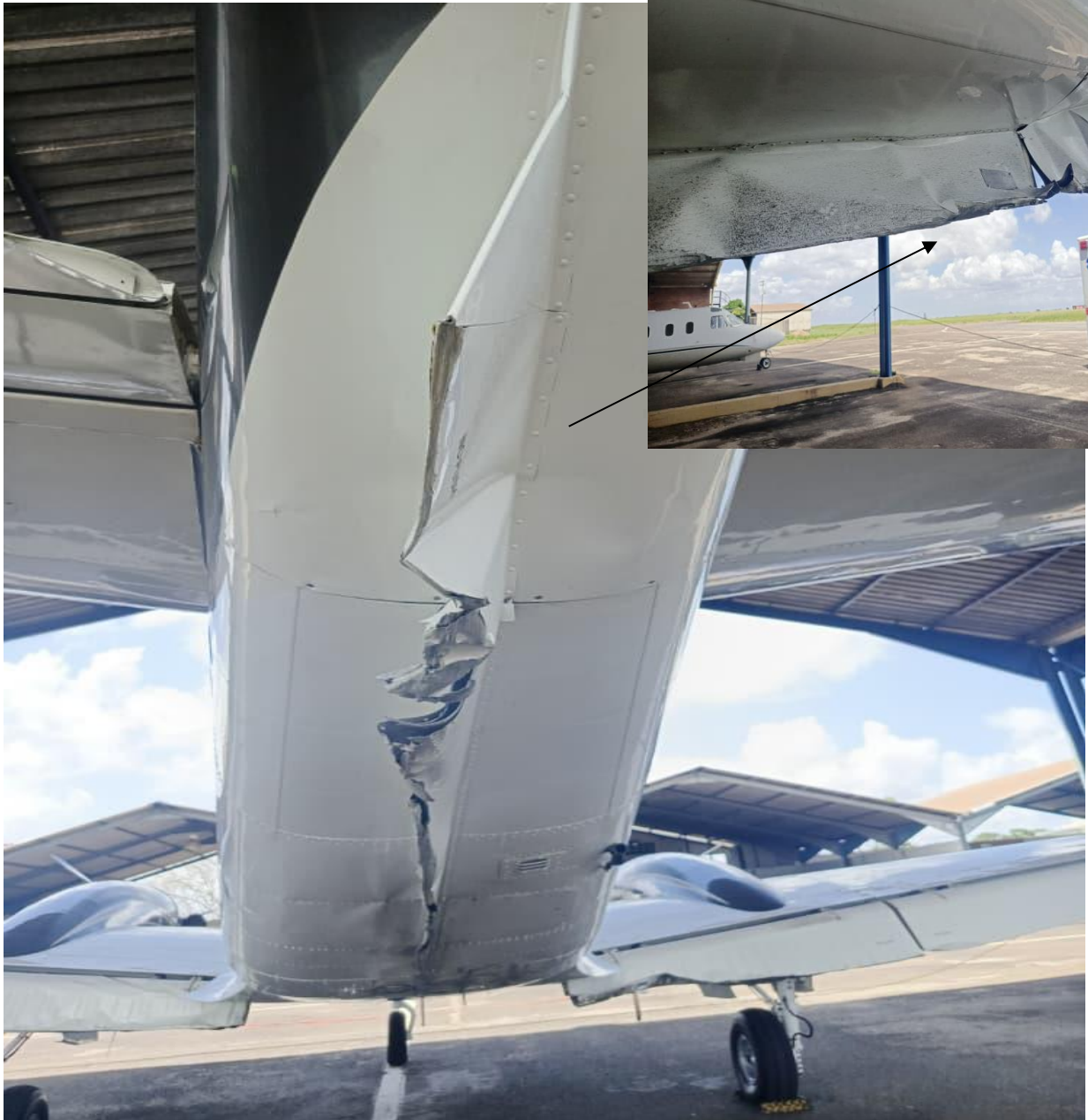
Figura 9. Daños en la aleta ventral del fuselaje, aeronave YV2410 Fuente: Investigador Encargado. Año: 2025
