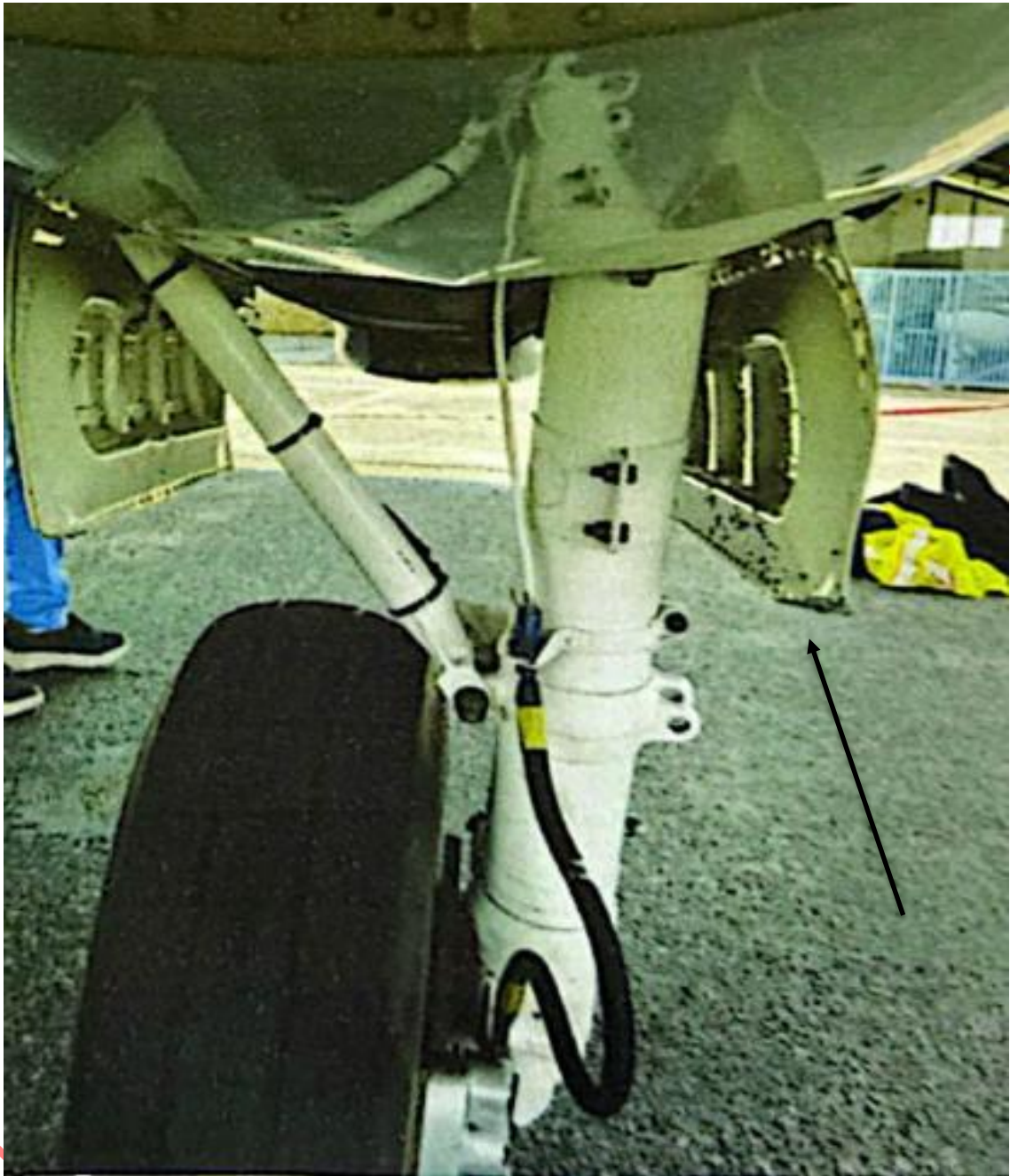
Figura 16. Daños Compuertas tren principal derecho, aeronave YV2410 Fuente: Investigador Encargado. Año: 2025
