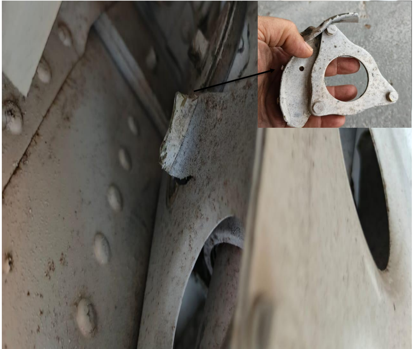
Figura 12. Base del actuador tren principal derecho, aeronave YV2410 Fuente: Investigador Encargado. Año: 2025
