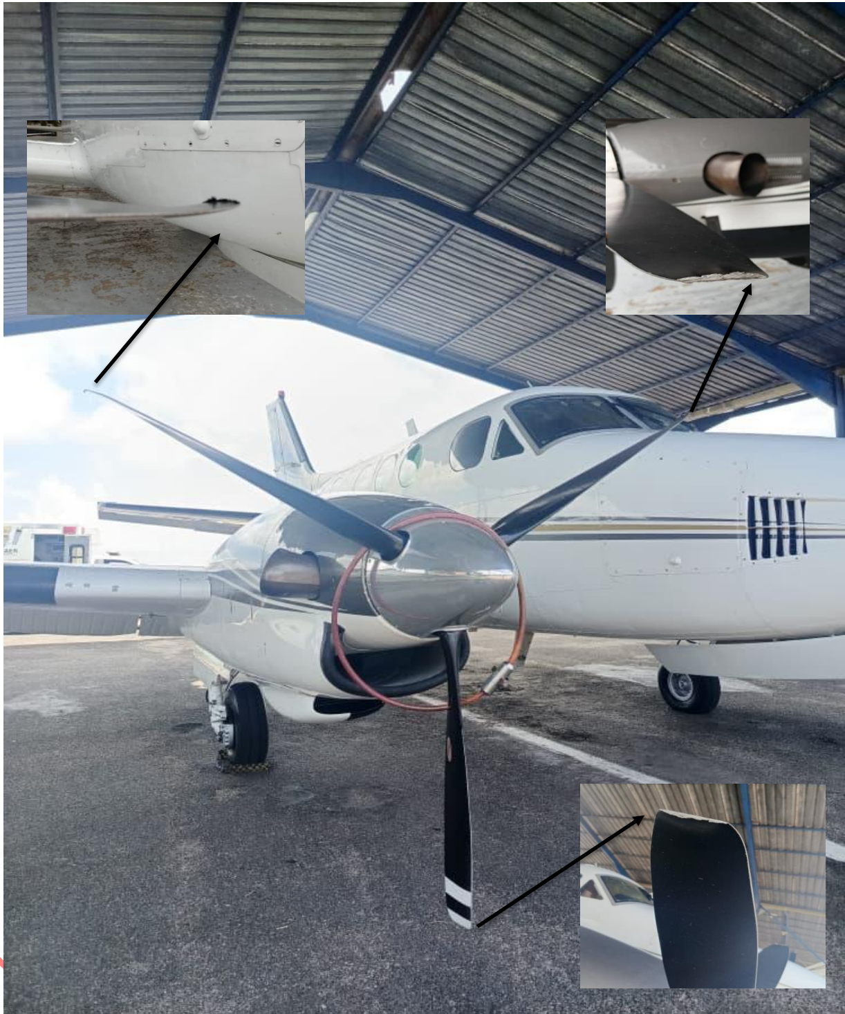
Figura 11. Daños en palas de la hélice derecha, aeronave YV2410 Fuente: Investigador Encargado. Año: 2025
