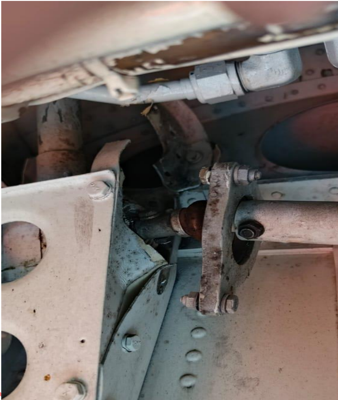
Figura 13. Base del actuador tren principal derecho, aeronave YV2410 Fuente: Investigador Encargado. Año: 2025
