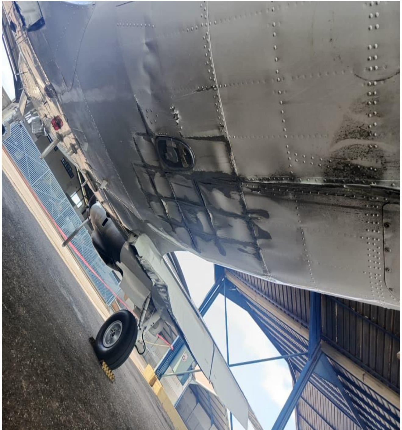
Figura 10. Daños en la parte inferior del fuselaje, aeronave YV2410 Fuente: Investigador Encargado. Año: 2025
