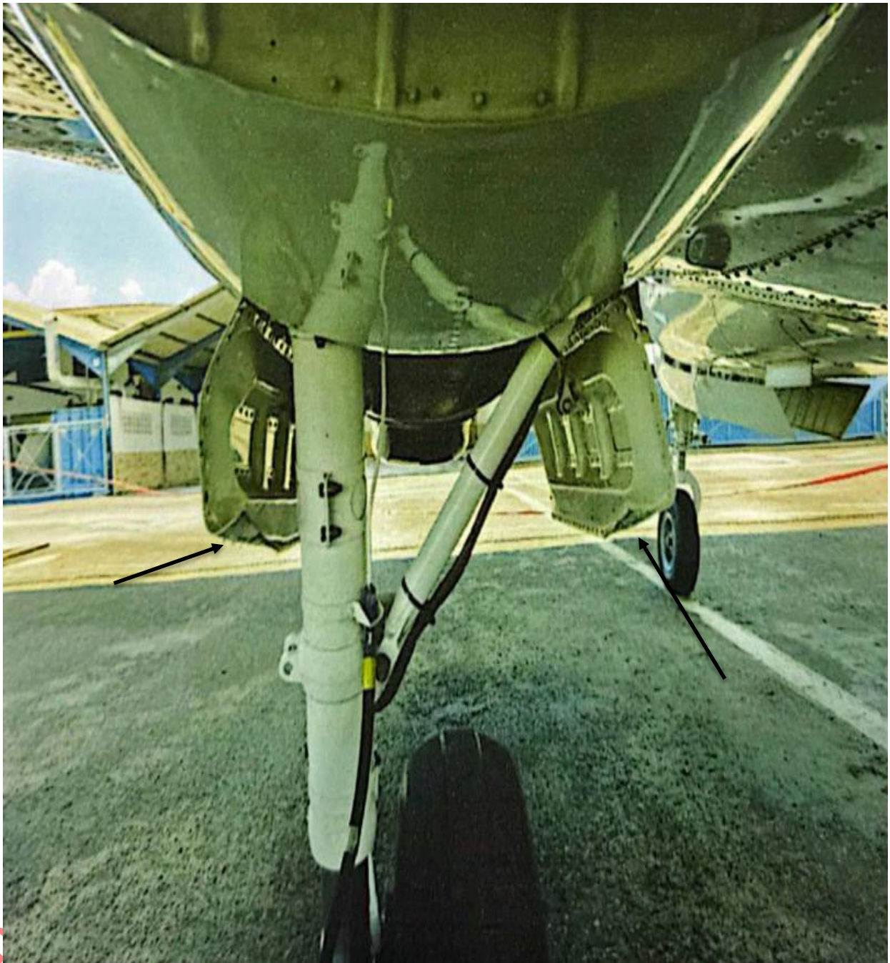
Figura 15. Daños Compuertas tren principal izquierdo YV2410 Fuente: Investigador Encargado. Año: 2025
