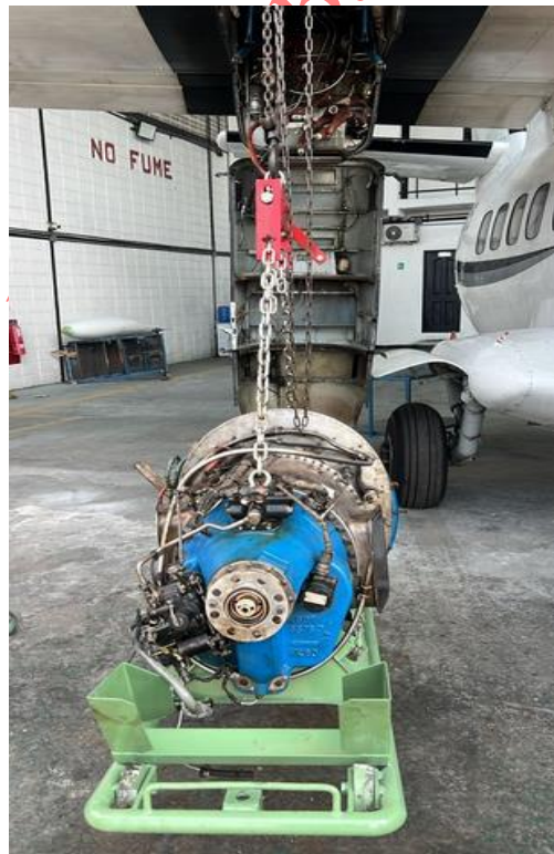
Figura 6. Motor N°2 Extraído, aeronave YV1515 Fuente: Investigador Encargado. Año: 2025
