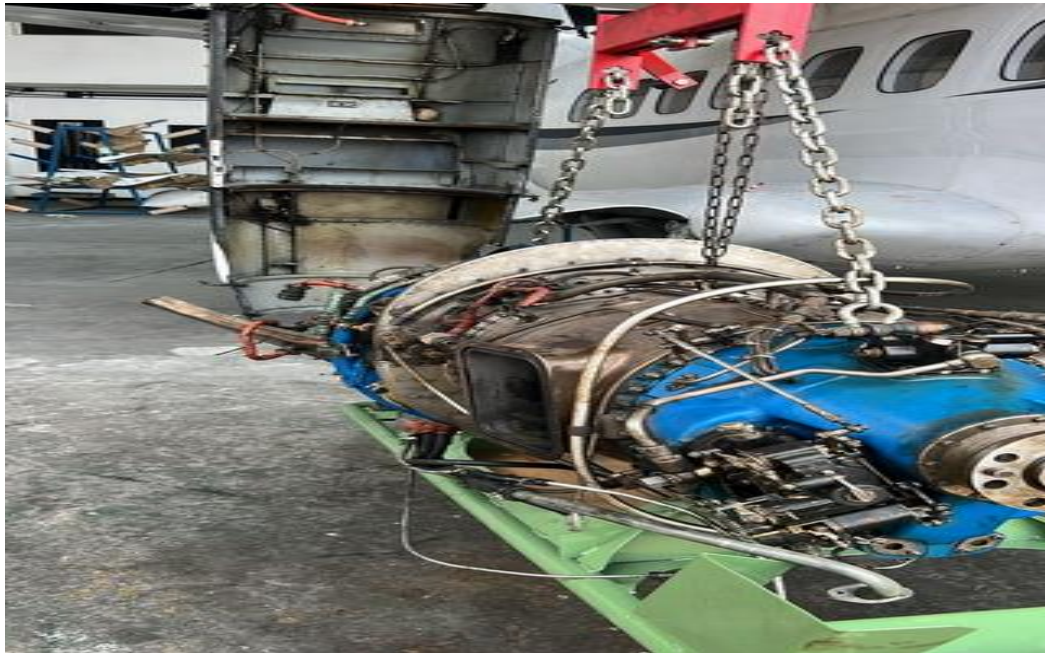
Figura 5. Motor N°2 Extraído, aeronave YV1515 Fuente: Investigador Encargado. Año: 2025
