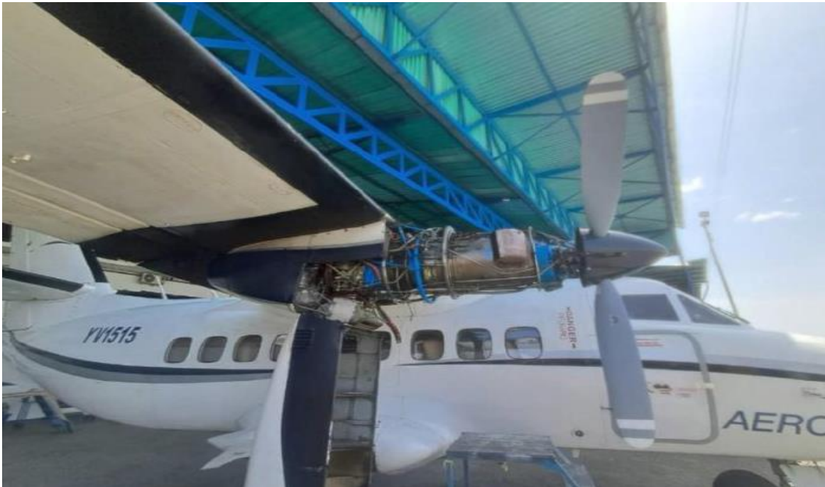
Figura 3. Inspección visual del motor N°2, Aeronave YV1515 Fuente: Investigador Encargado. Año: 2025
