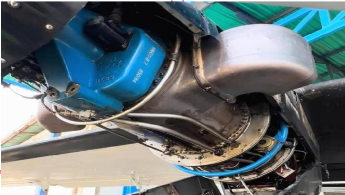
Figura 4. Motor N°2 en proceso de extracción, aeronave YV1515 Fuente: Investigador Encargado. Año: 2025
