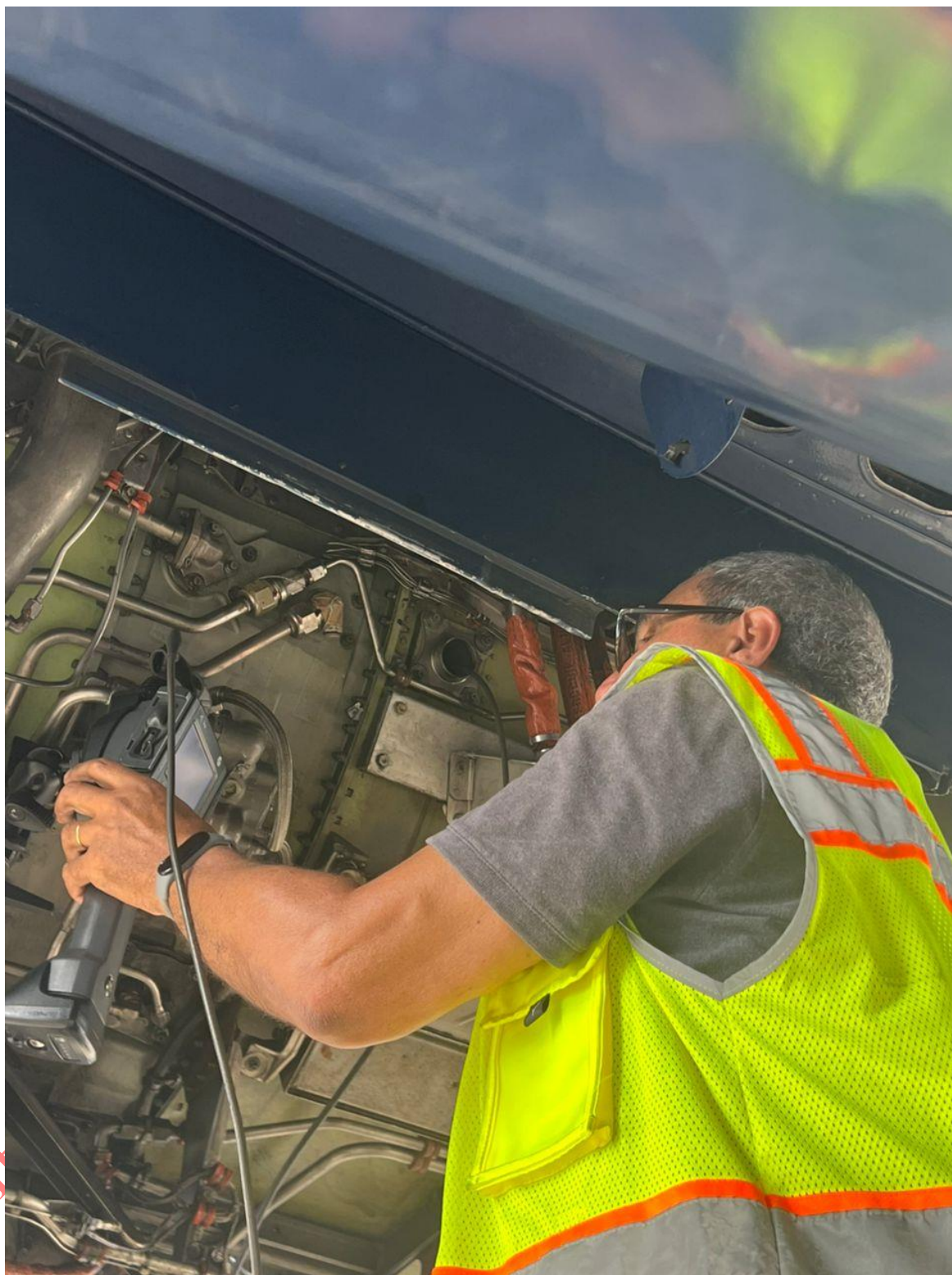
Figura 4. Inspección Boroscópica Motor N°2 aeronave YV3499. Fuente: Investigador Encargado. Año: 2025
