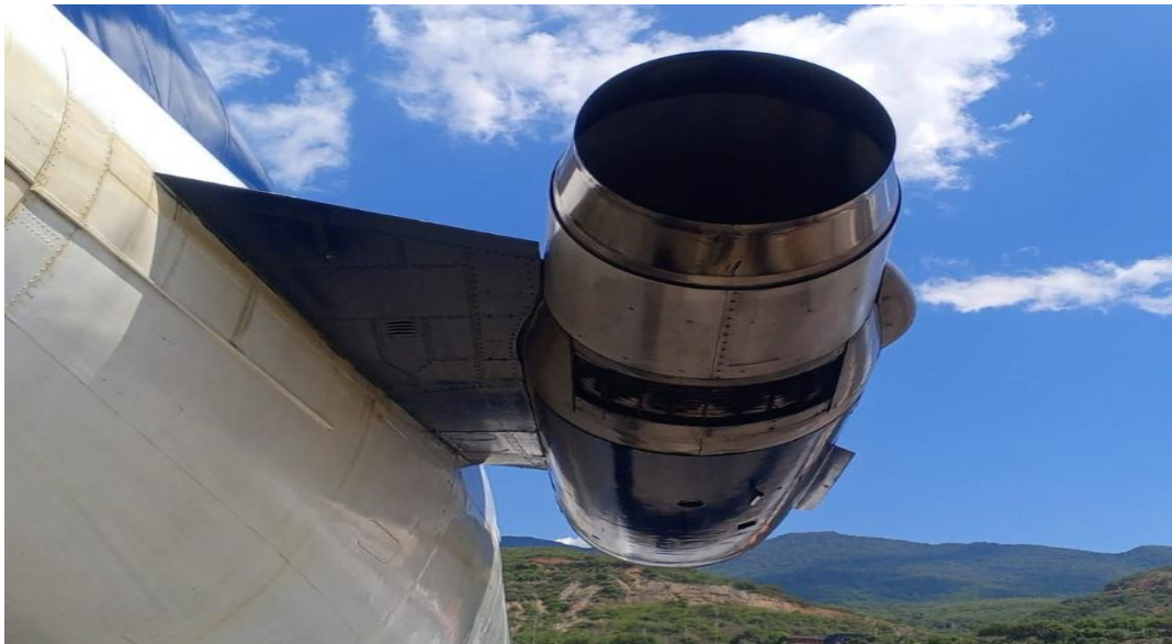
Figura 5. Inspección Motor N° 3 sin daños externos, aeronave YV665T Fuente: Investigador Encargado. Año: 2025
