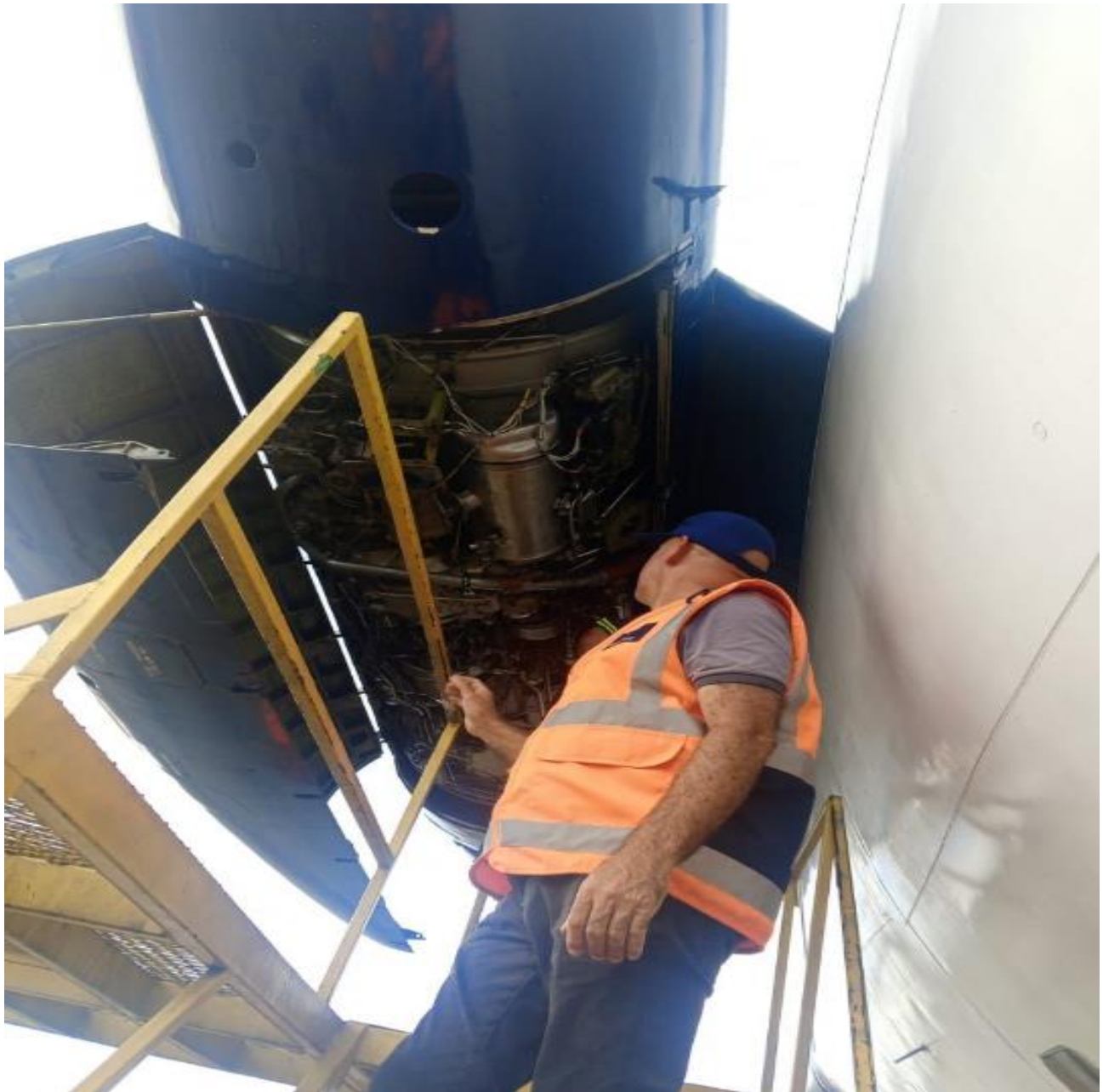
Figura 4. Inspección visual del motor N°3, aeronave YV665T Fuente: Investigador Encargado. Año: 2025
