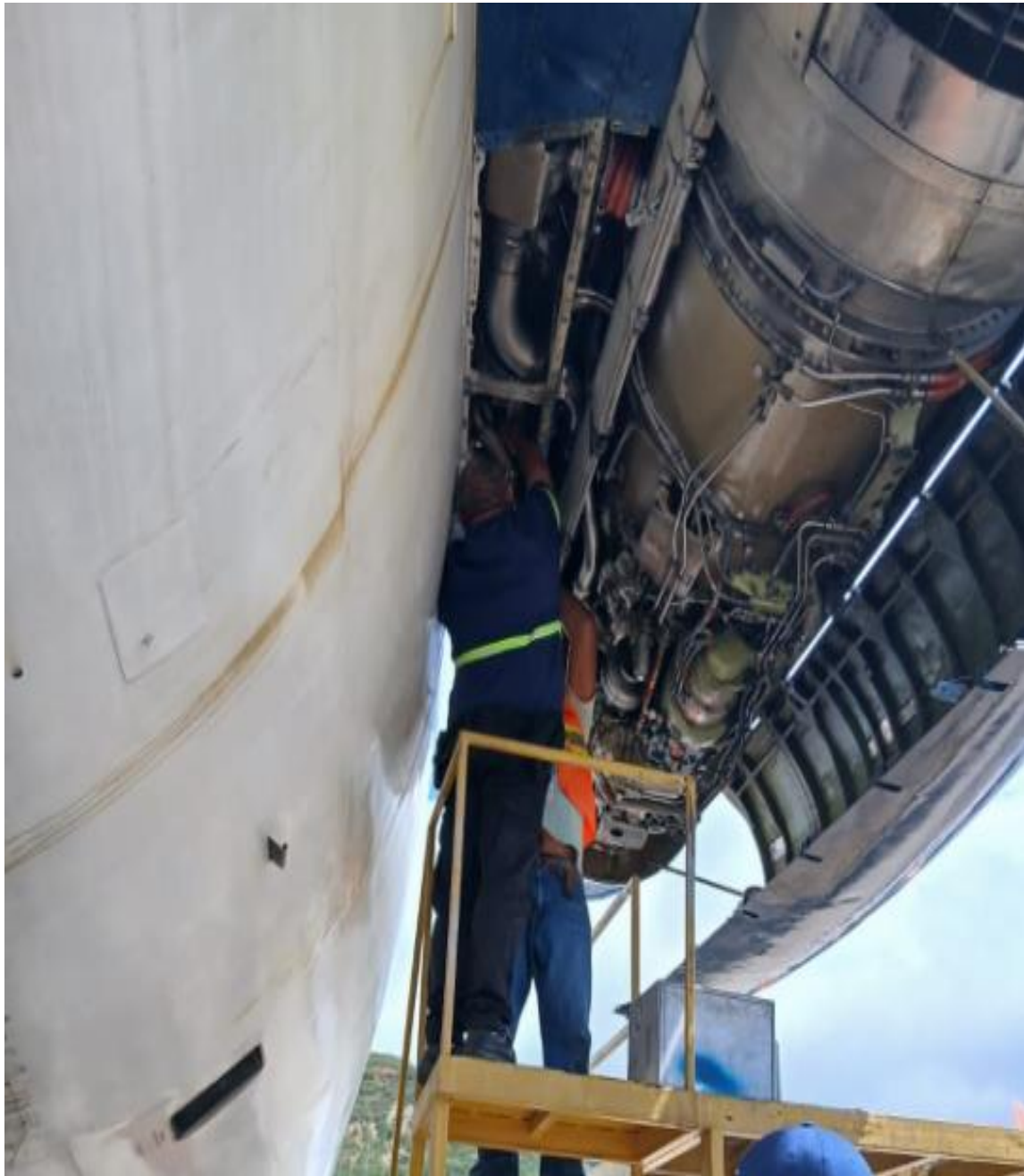
Figura 7. Ajuste del sistema de neumático del motor N°3, aeronave YV665T
