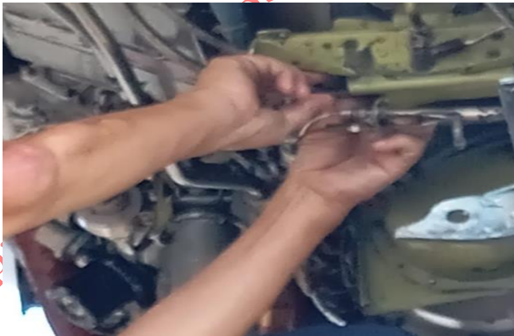
Figura 9. Ajuste del Loop, aeronave YV665T Fuente: Investigador Encargado. Año: 2025
