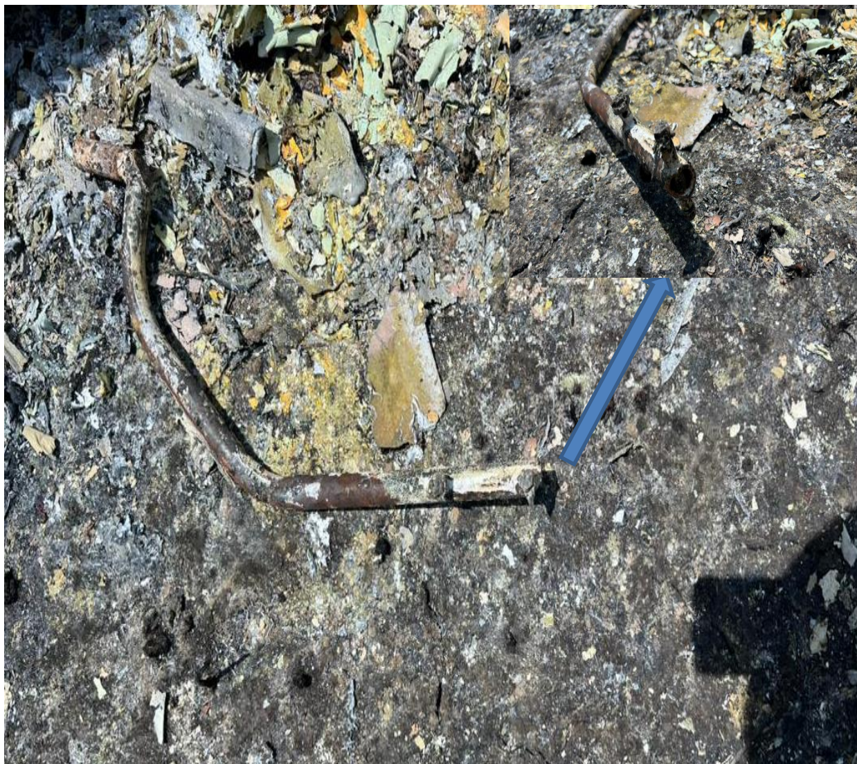
Figura 8. Bastón de Mando fracturado YV156A.
