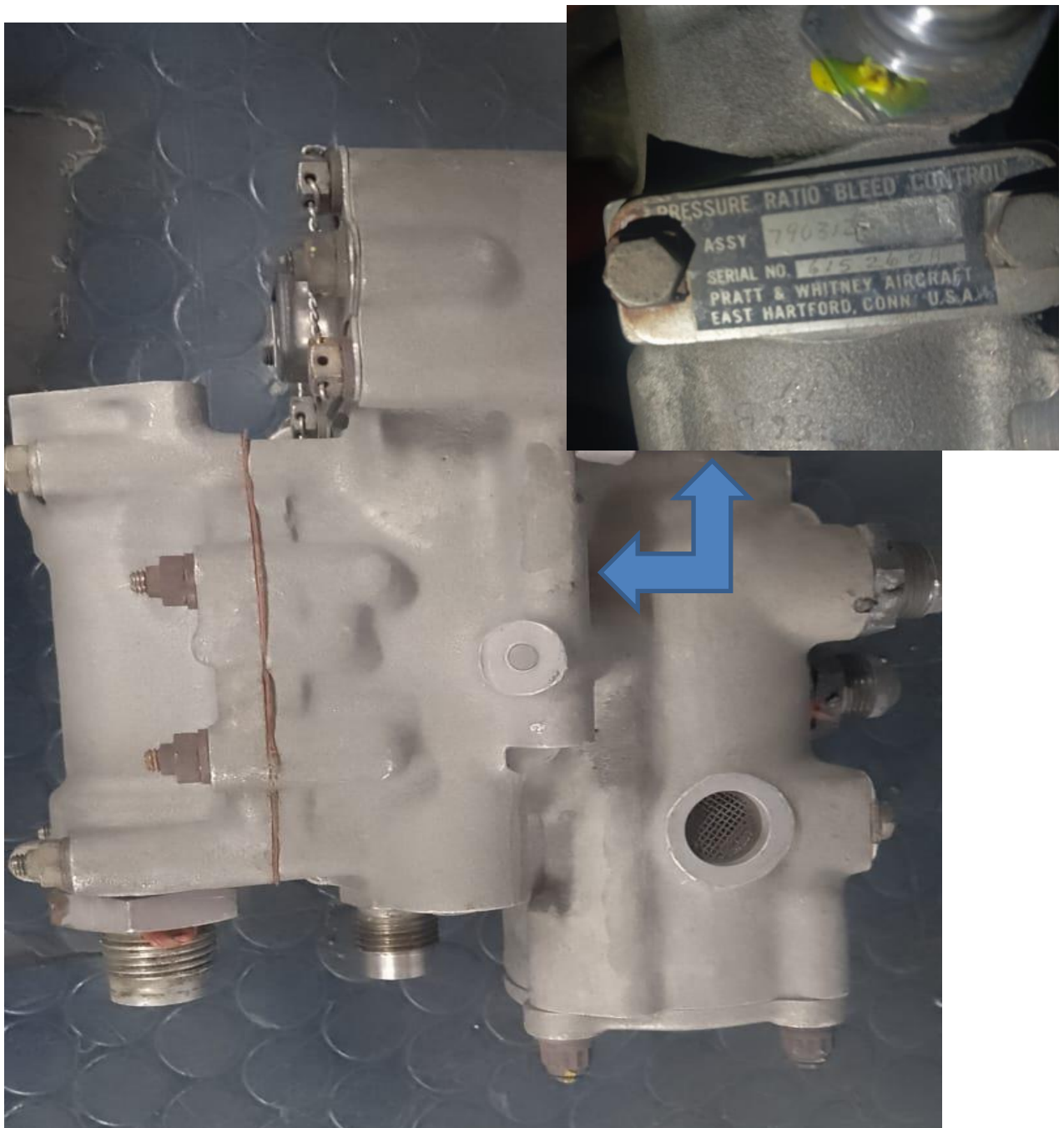
Figura 6. Serial del PRESSURE RATIO BLEED CONTROL instalada YV3471. Fuente: Investigador Encargado. Año: 2025
