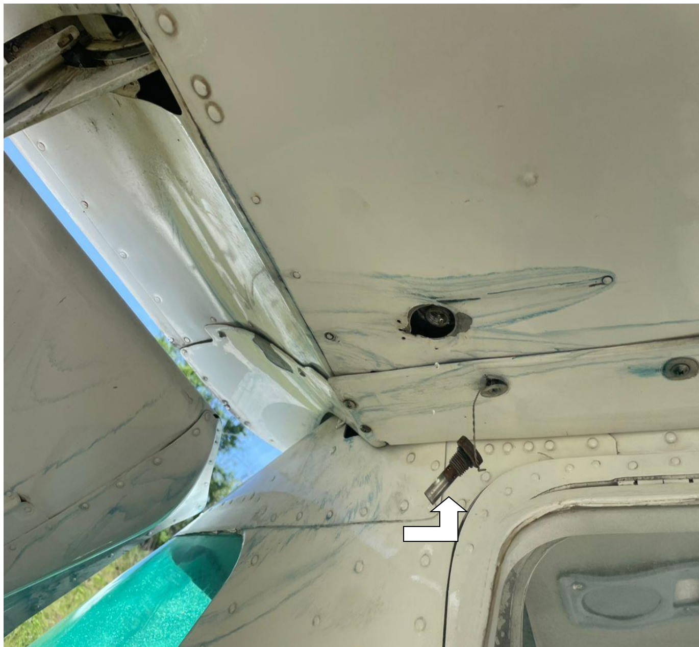
Imagen 4: Luego de la inspección se pudo constatar que la válvula de drenaje del tanque derecho estaba suelta. YV104E.
