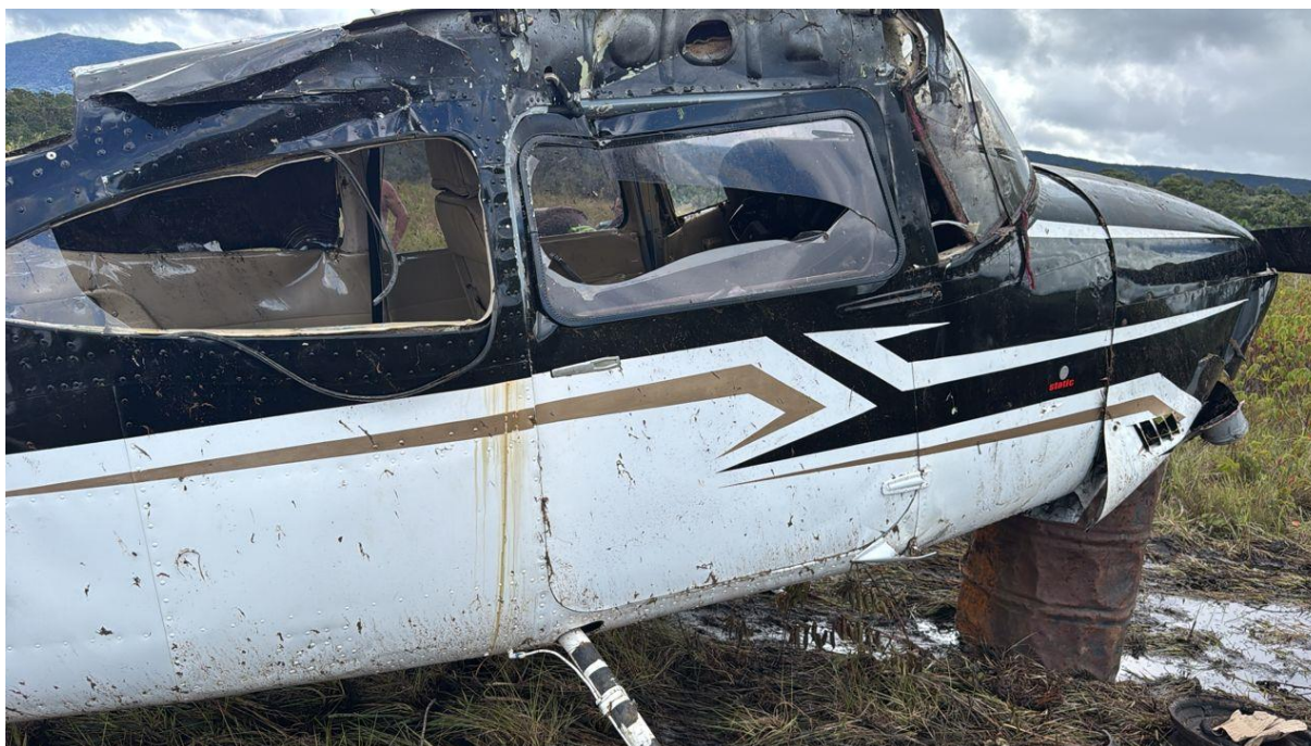
Imagen 8: Daños en las ventanas y fuselaje YV 2438. Fuente: Investigador Encargado Año: 2025
