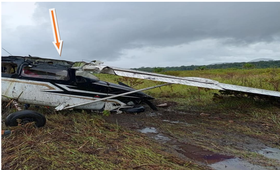
Imagen 6: Plano Derecho Desprendido YV2438. Fuente: Investigador Encargado Año: 2025
