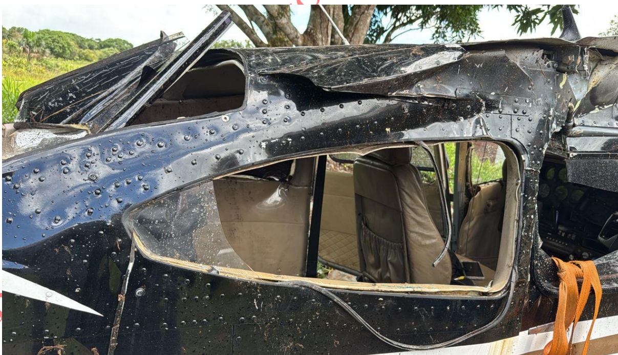
Imagen 9: Daños en el fuselaje y ventanas YV 2438. Fuente: Investigador Encargado Año: 2025
