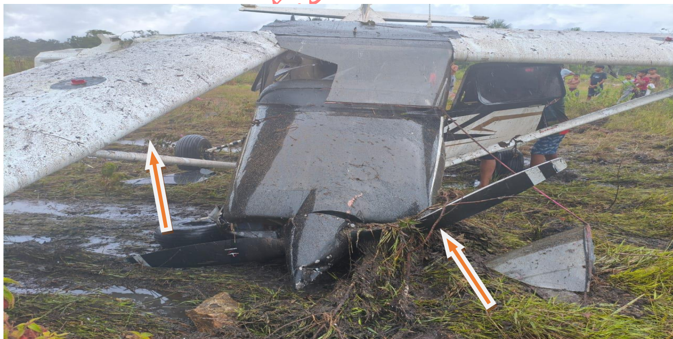
Imagen 5: Daños plano Derecho y Palas YV2438. Fuente: Investigador Encargado Año: 2025
