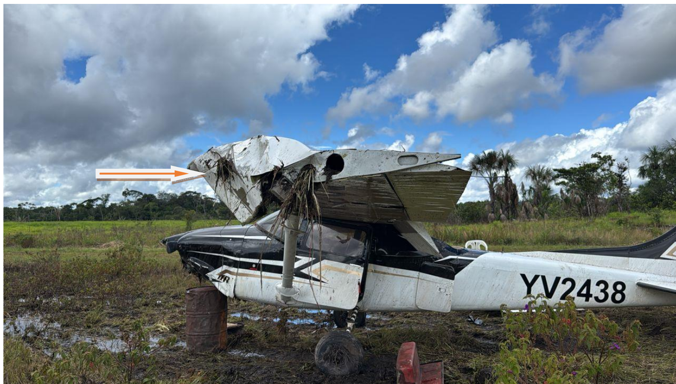
Imagen 4: Daños plano izquierdo YV2438. Fuente: Investigador Encargado Año: 2025
