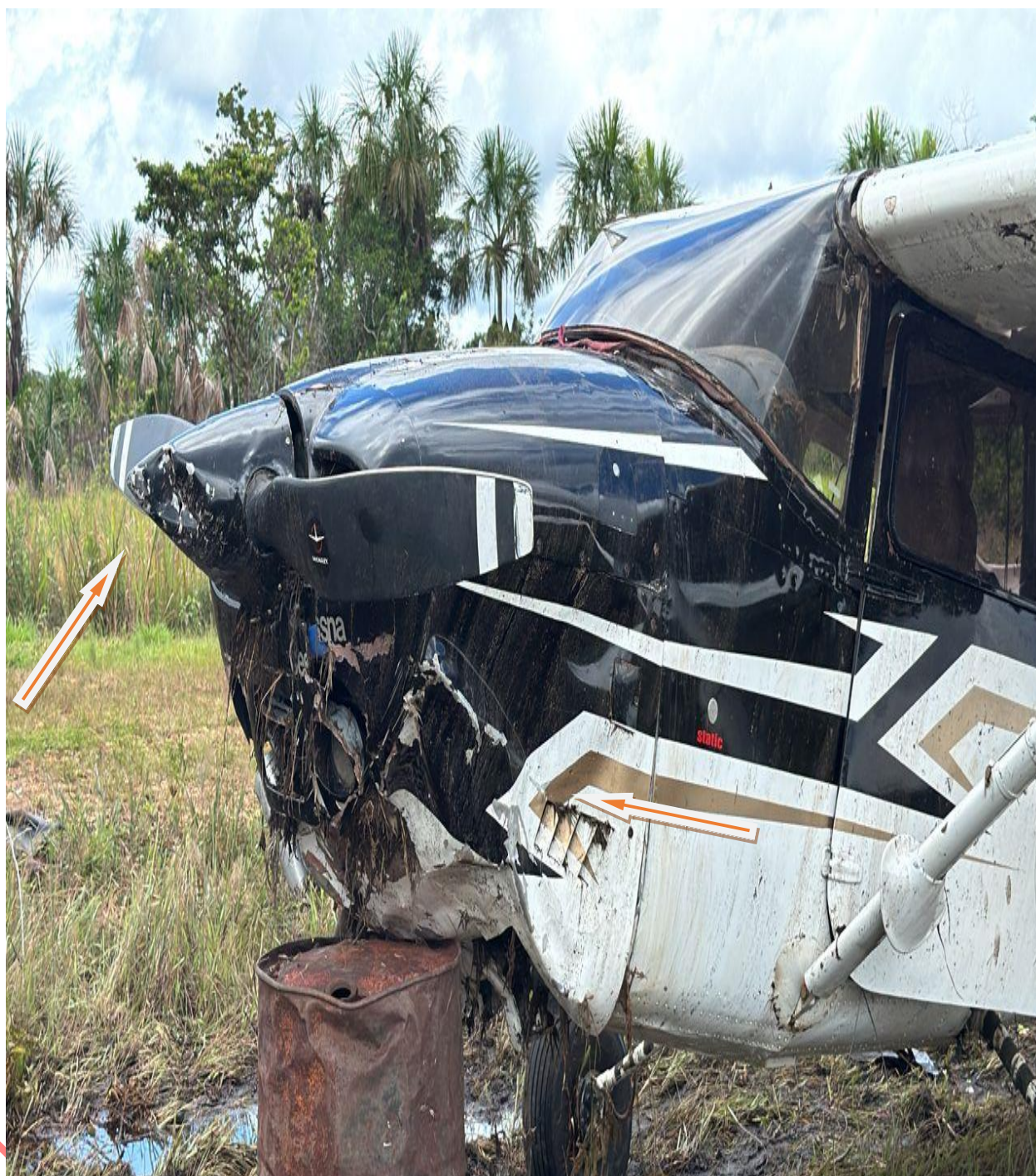
Imagen 3. Daños en el Spinner, palas y fuselaje YV 2438 Fuente: Investigador Encargado Año: 2025.
