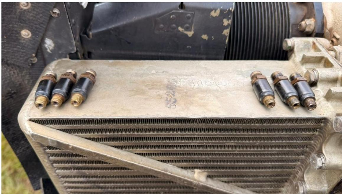
**Figura 6.** Inspección de inyectores de la aeronave YV1983
