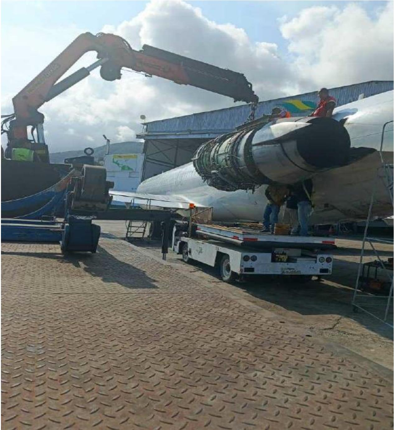
**Figura 2.** Remoción del Motor de la aeronave YV2945
