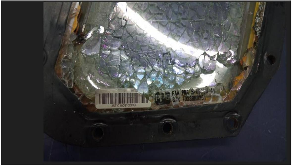
**Figura 4.** Vidrio R5 fracturado, aeronave YV657T.
