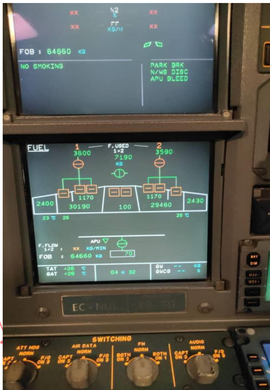
Figura 2. Inspección del sistema de combustible de la Aeronave EC-NUL. Fuente: Investigador Encargado Año: 2025
