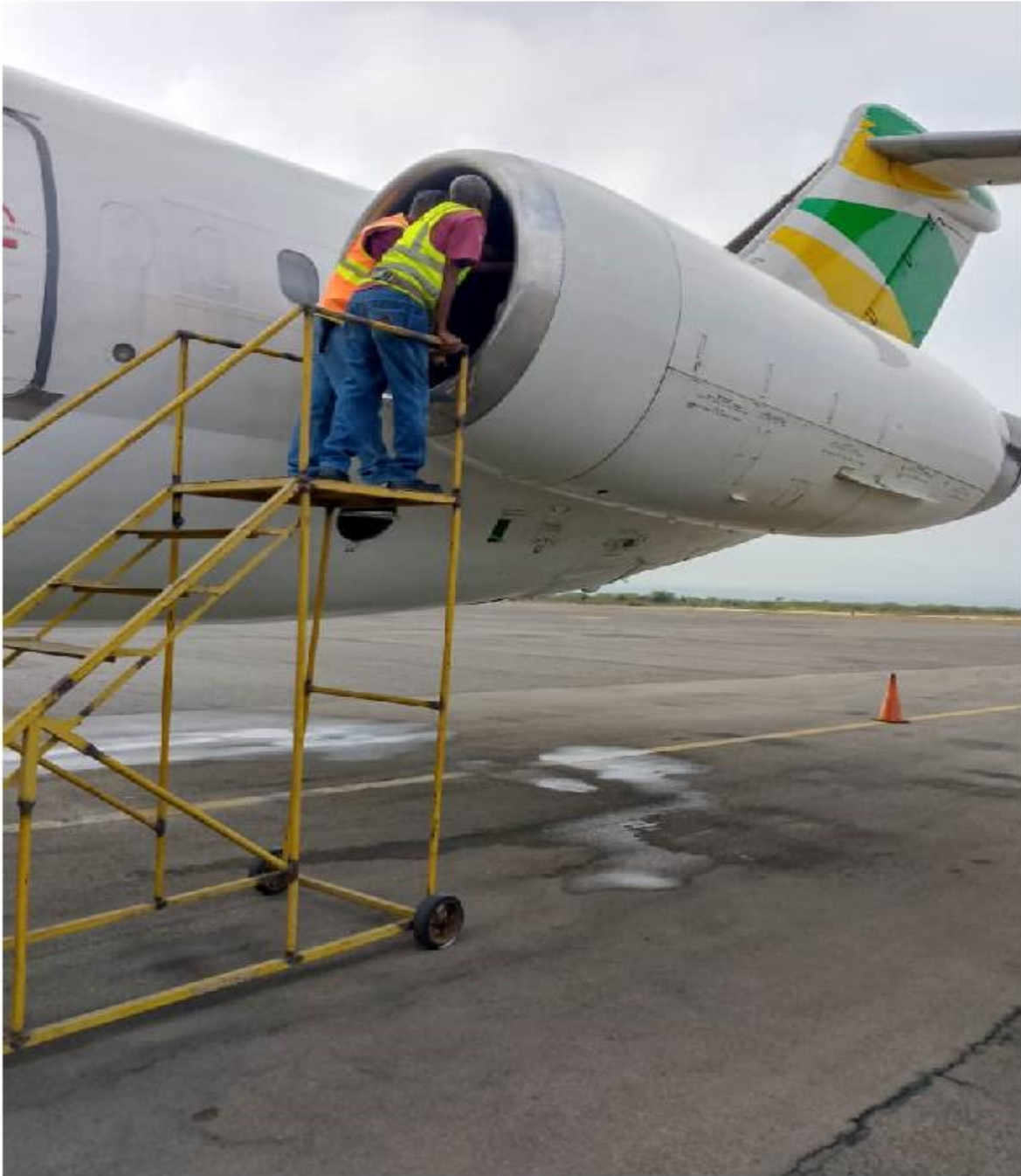
Figura 6. Inspección del Motor Izquierdo para el cambio de la corona de alabes de la primera etapa Aeronave YV3145.
