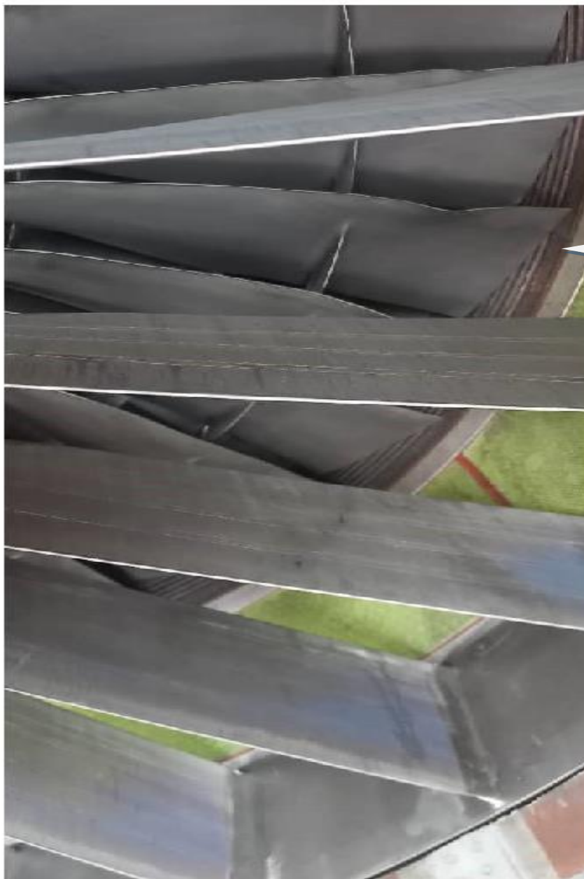
Figura 5. Alabes doblados del Motor Izquierdo Aeronave YV3145. Fuente: Investigador Encargado Año: 2025
