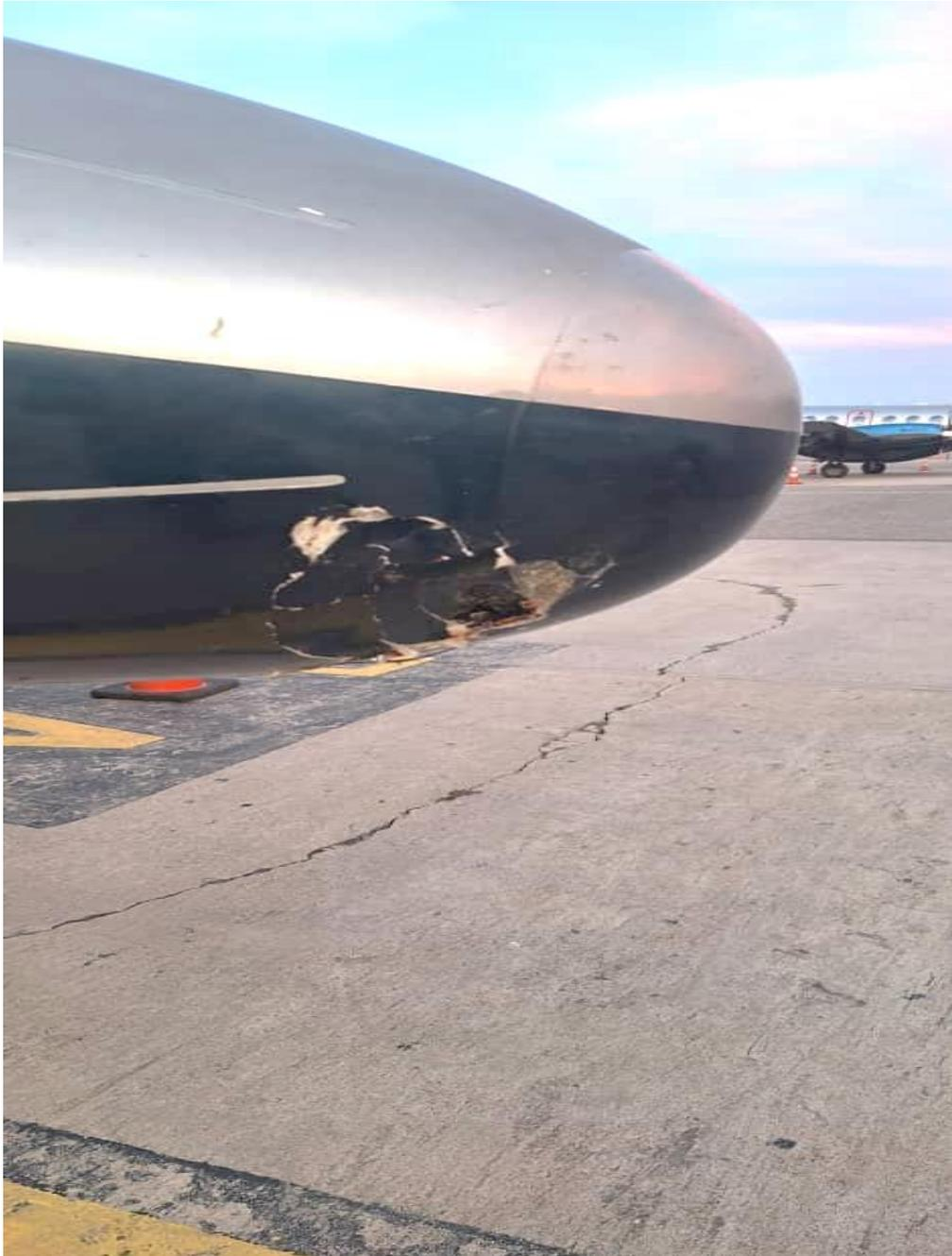
Figura 3. Daños en el Radomo de la Aeronave YV3438.
