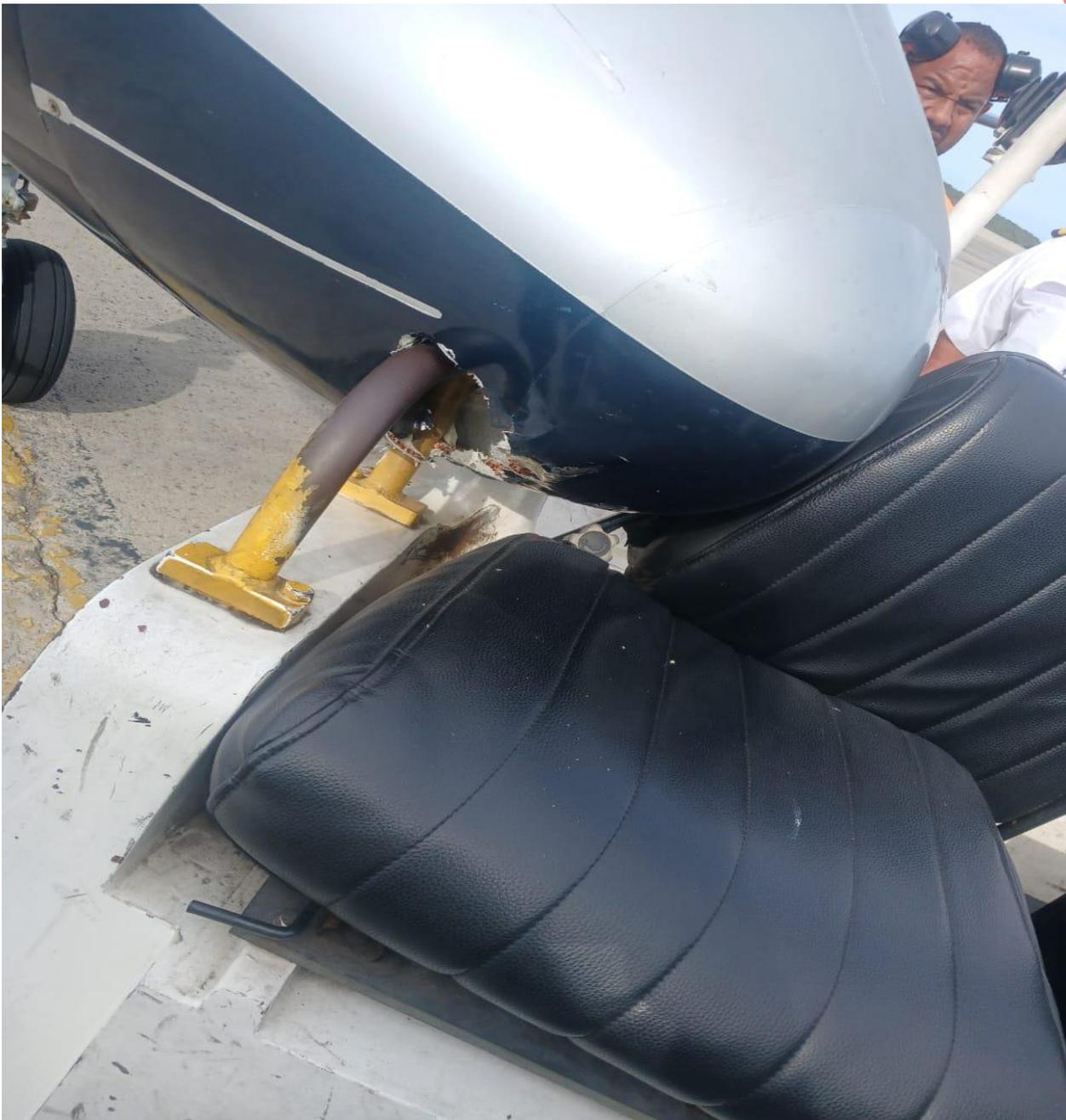
Figura 2. Impacto con el tractor de arrastre Aeronave YV3438.
