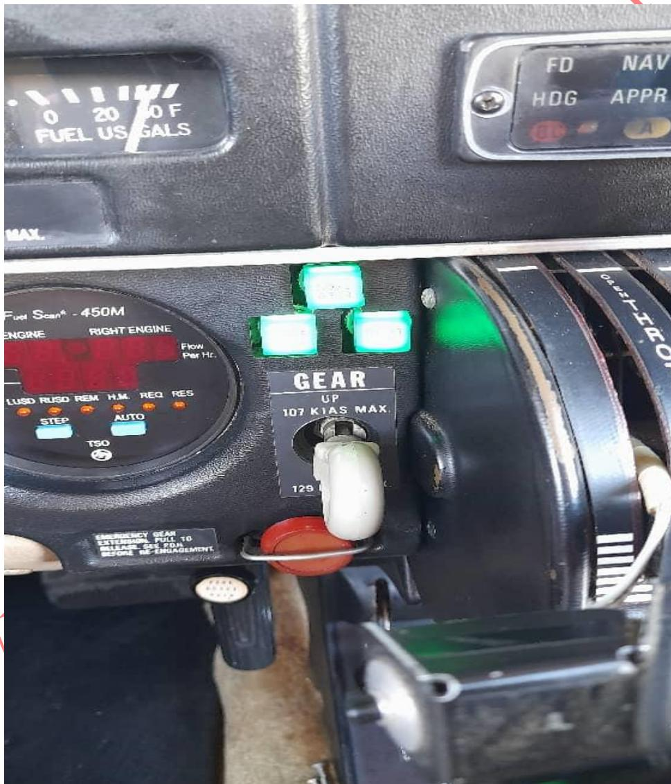
Figura 2. Inspección de la Palanca y sistema eléctrico del tren de aterrizaje YV2007.
