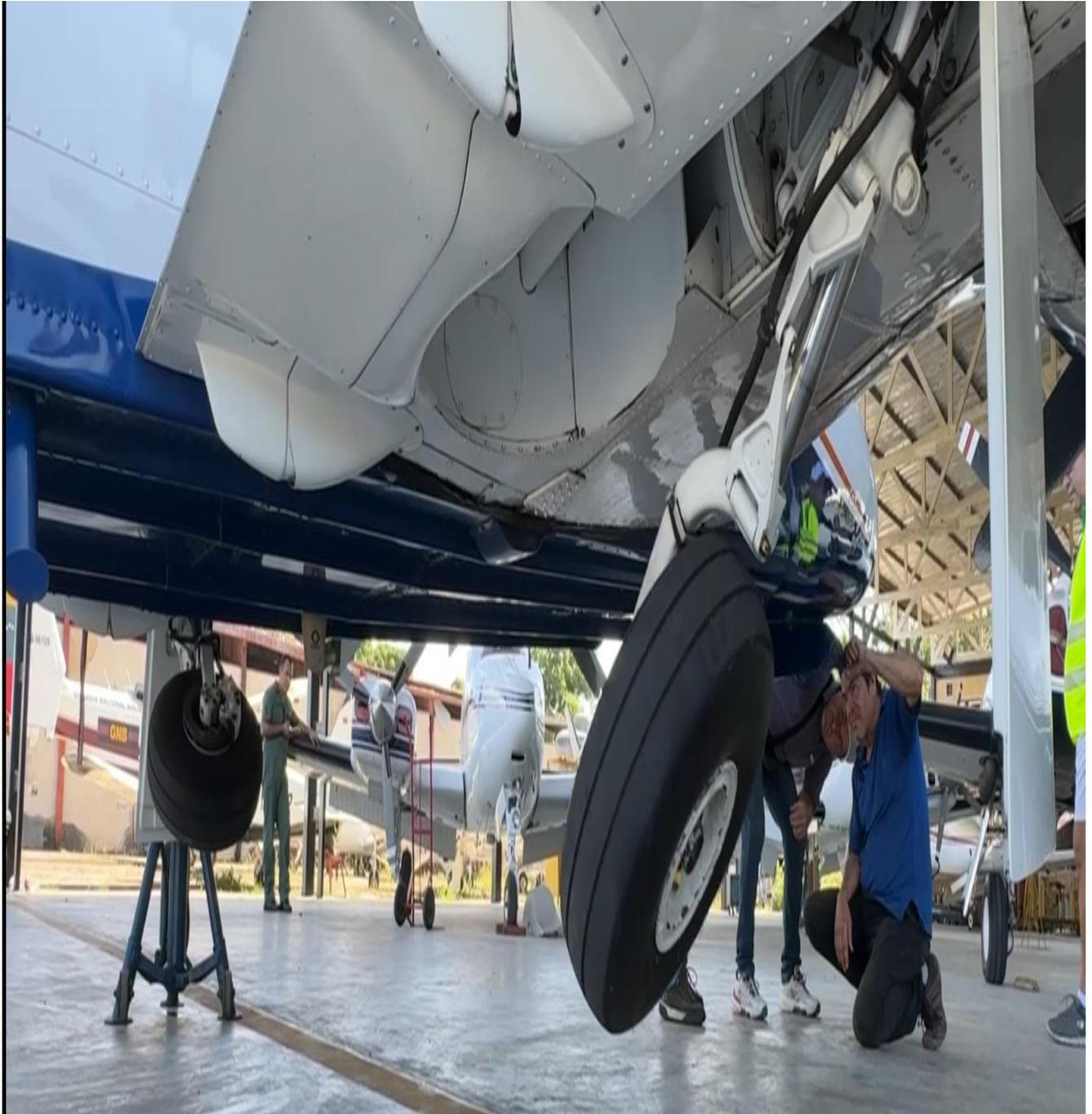
Figura 7. Inspección del Tren de Aterrizaje sin novedad YV2007.
