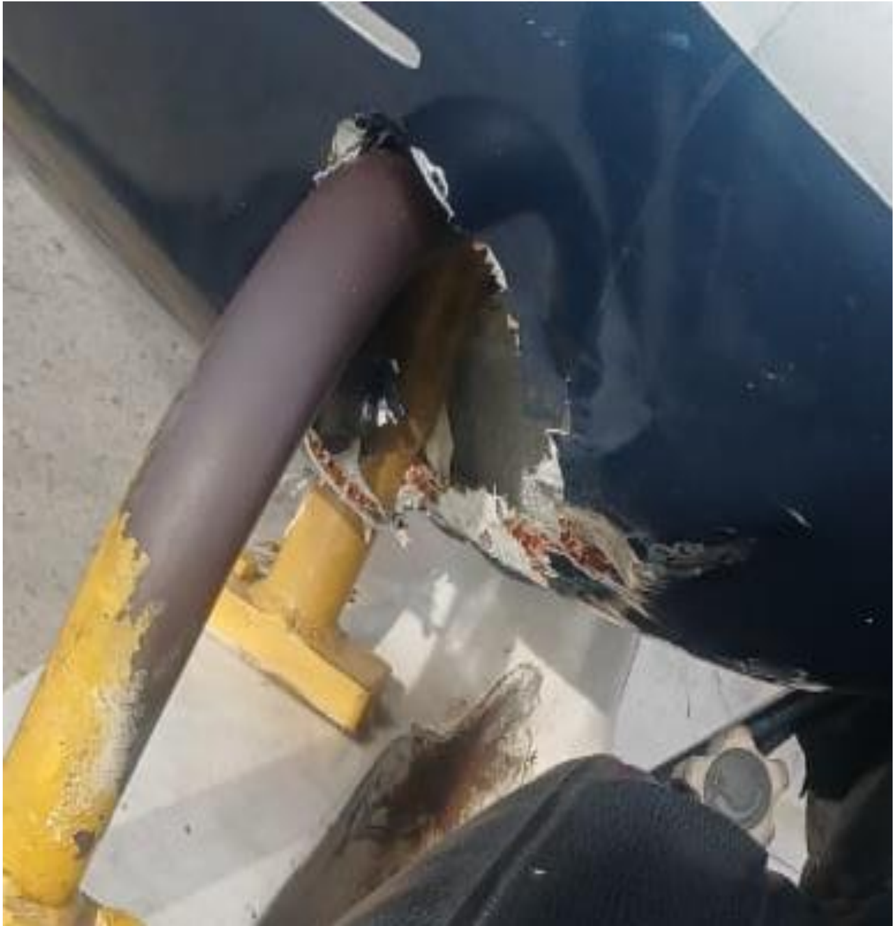
Figura 4. Daños en el Radomo como resultado del impacto con el tractor de arrastre. Aeronave YV3438.
