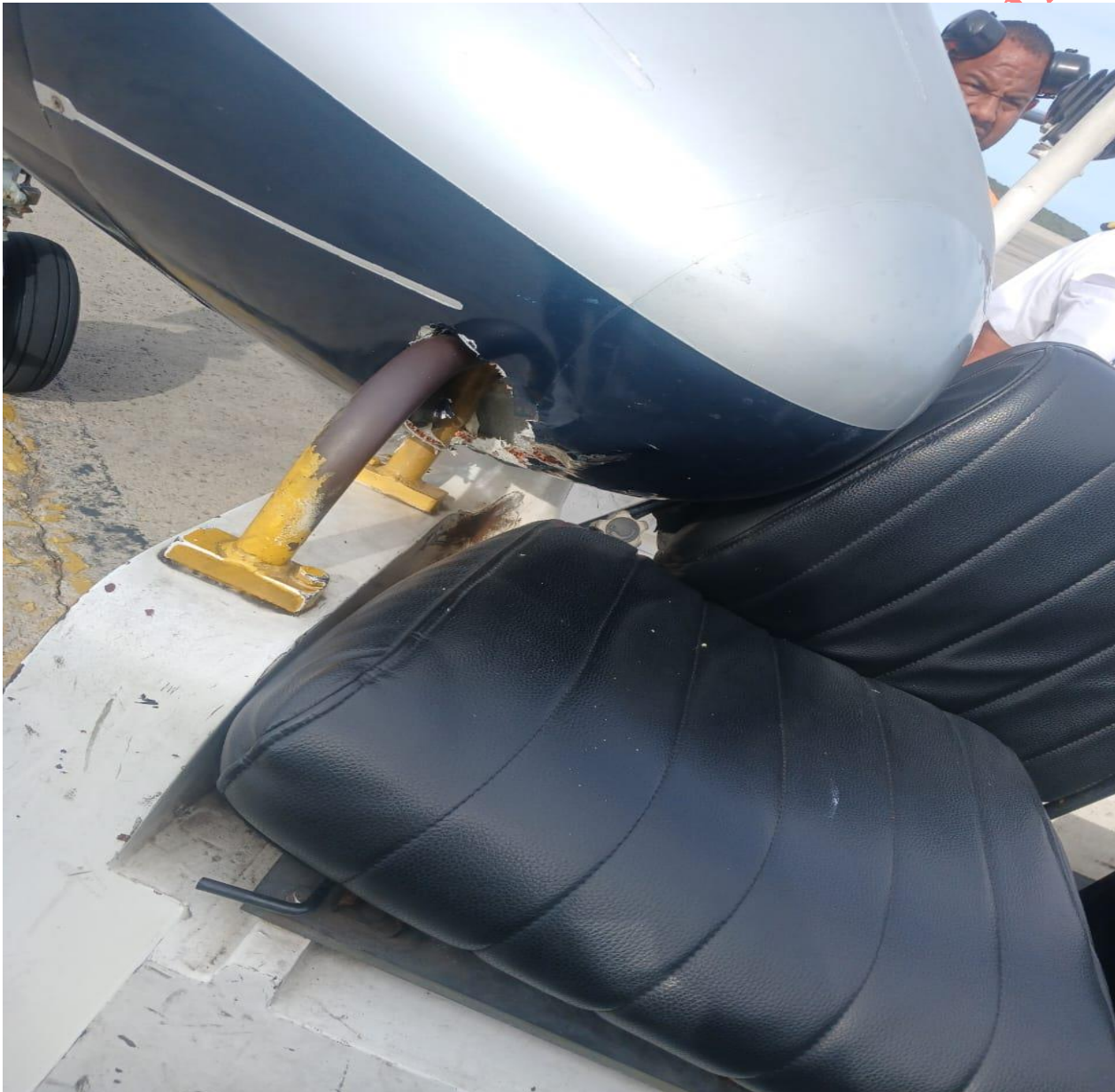
Figura 2. Impacto con el tractor de arrastre. Aeronave YV3438. Fuente: Investigador Encargado Año: 2025
