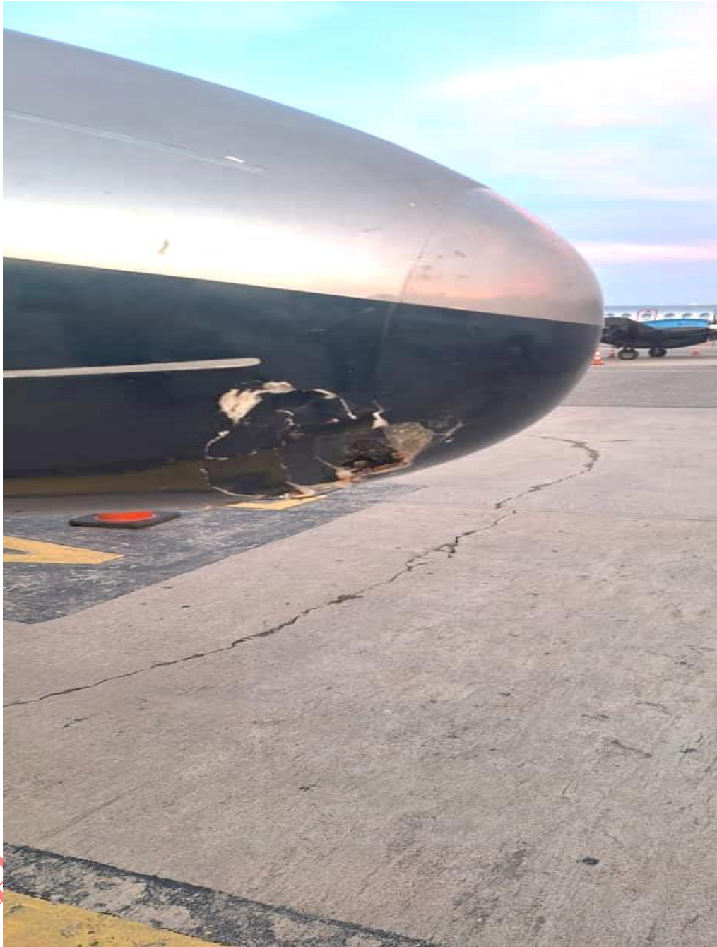
Figura 3. Daños en el Radomo de la Aeronave YV3438. Fuente: Investigador Encargado Año: 2025
