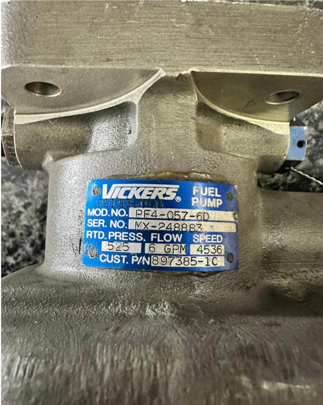
**Figura 2.** Serial de la bomba de combustible que será instalada en la aeronave YV2724.
