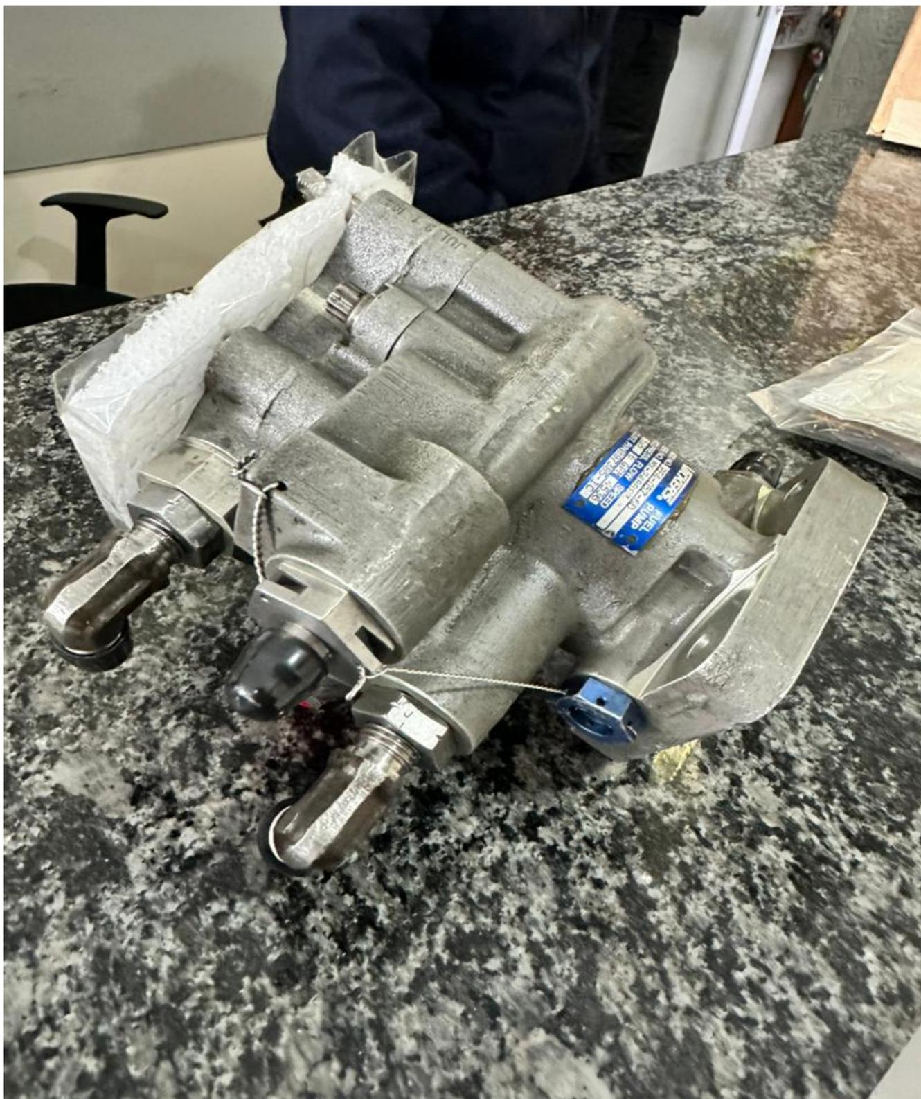
**Figura 5.** Bomba de combustible nueva que será instalada a la aeronave YV2724.
