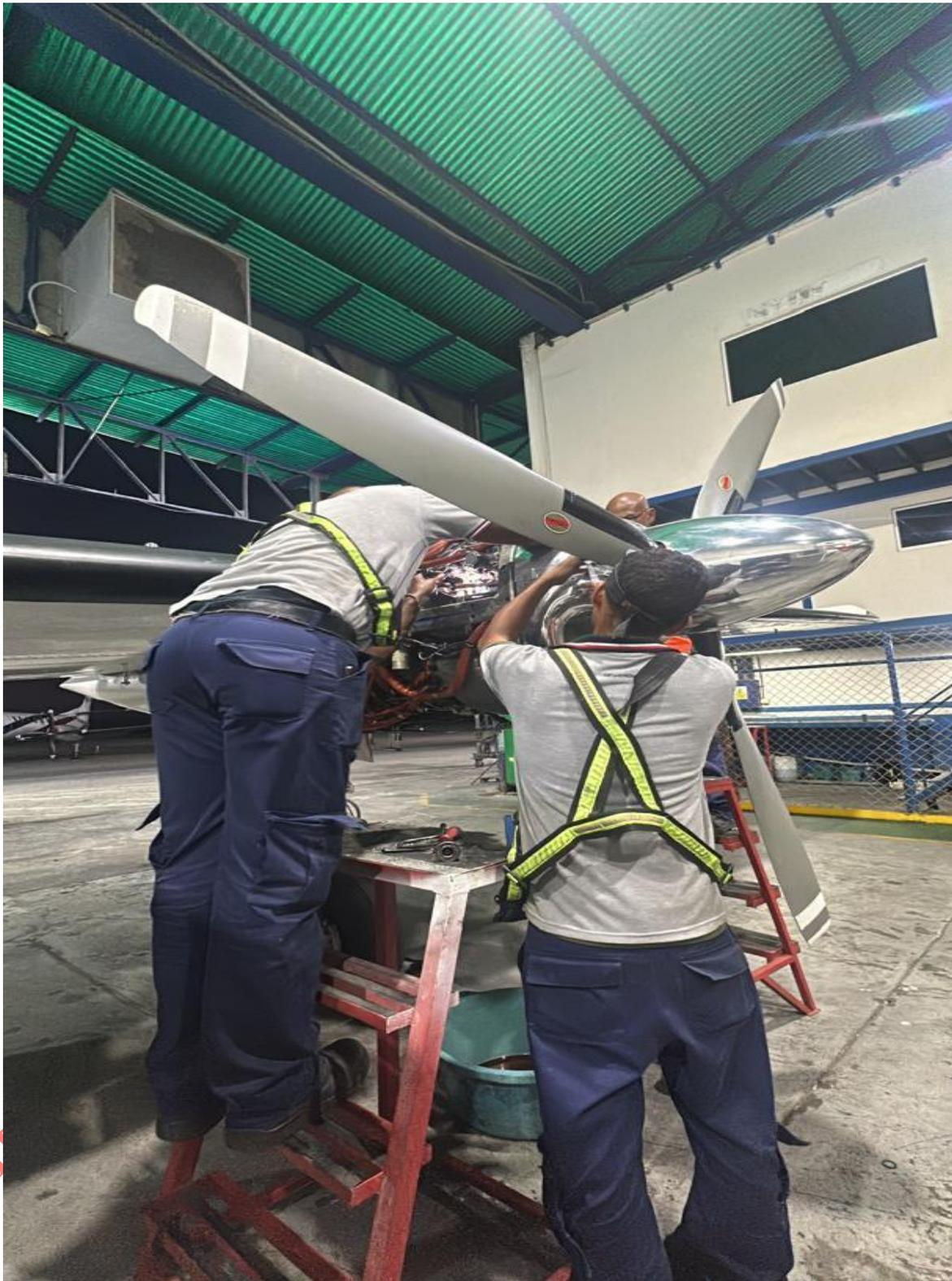
**Figura 8.** Instalación de la bomba de combustible a la aeronave YV2724.
