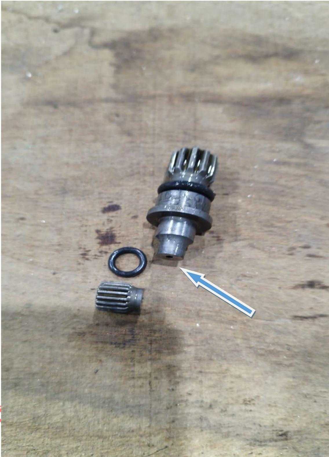
**Figura 6.** Eje impulsor fracturado de la bomba de combustible de la aeronave YV2724.
