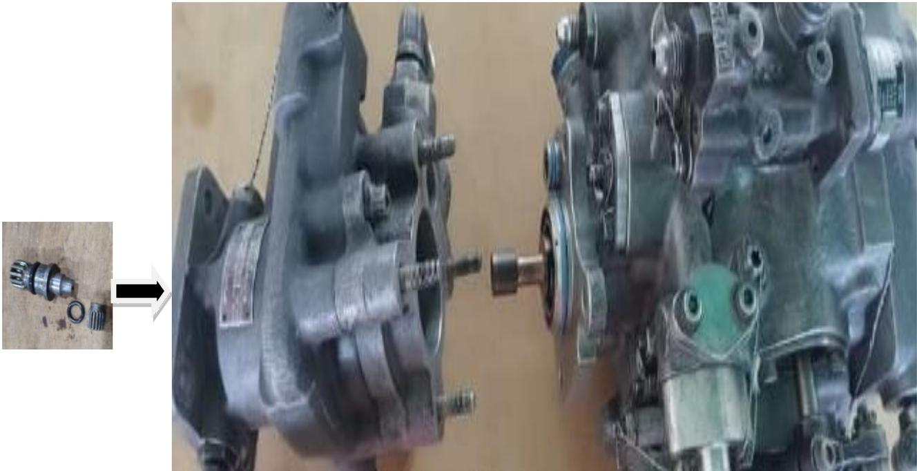
**Figura 10.** Secuencia de instalación de bomba de combustible y FCU donde se observa el eje de acople de la bomba con la caja de engranajes del motor izquierdo S/N P-06248.
