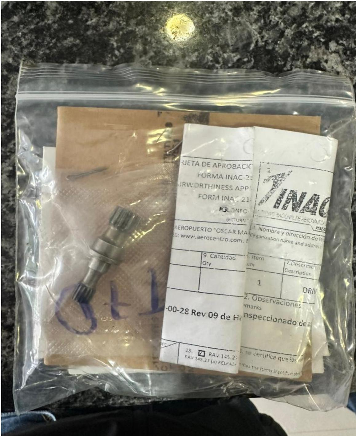
Figura 3. Eje impulsor de la bomba de combustible.
