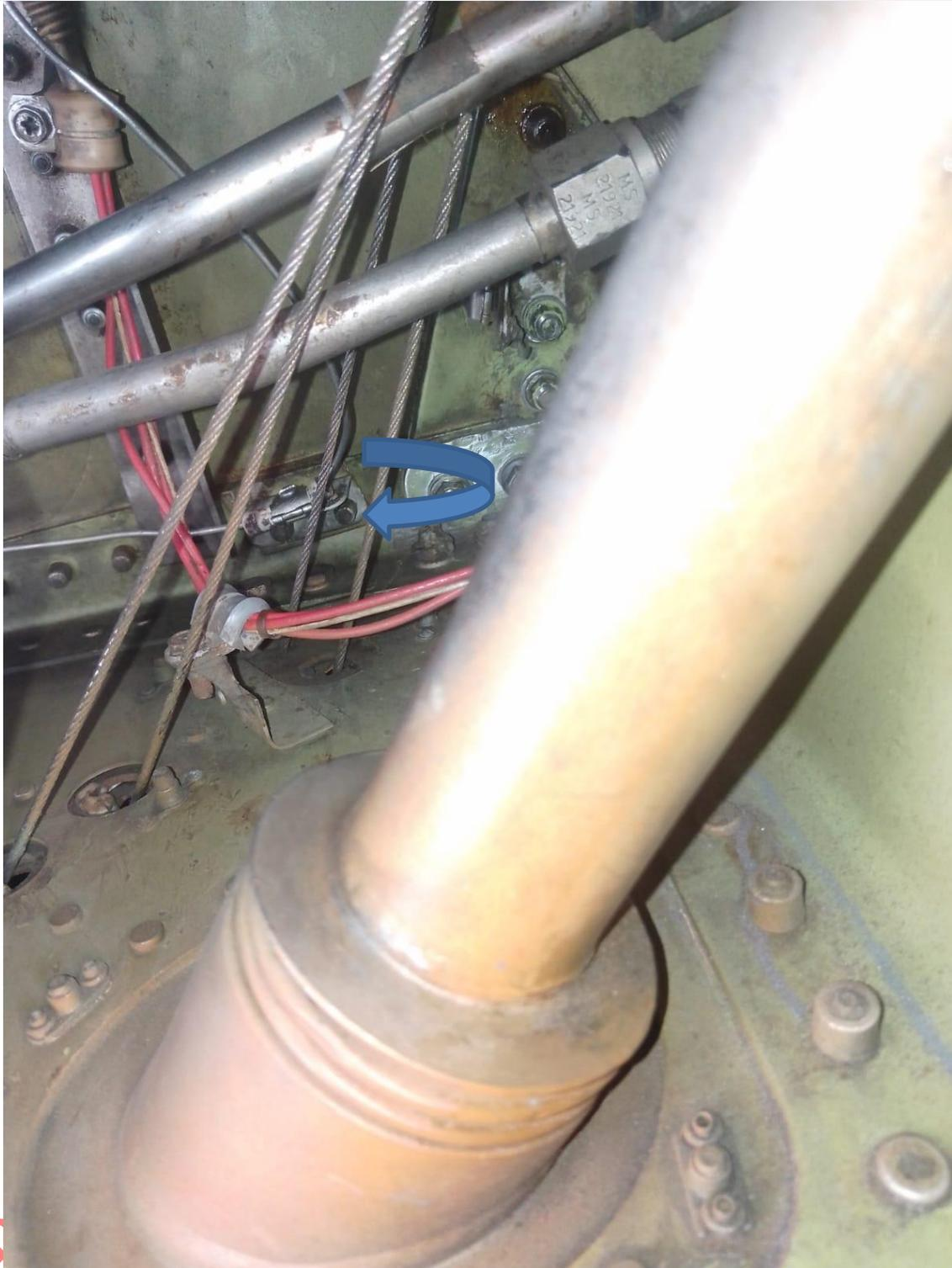
**Imagen 10:** Ajuste de Sonda HK 5239.
