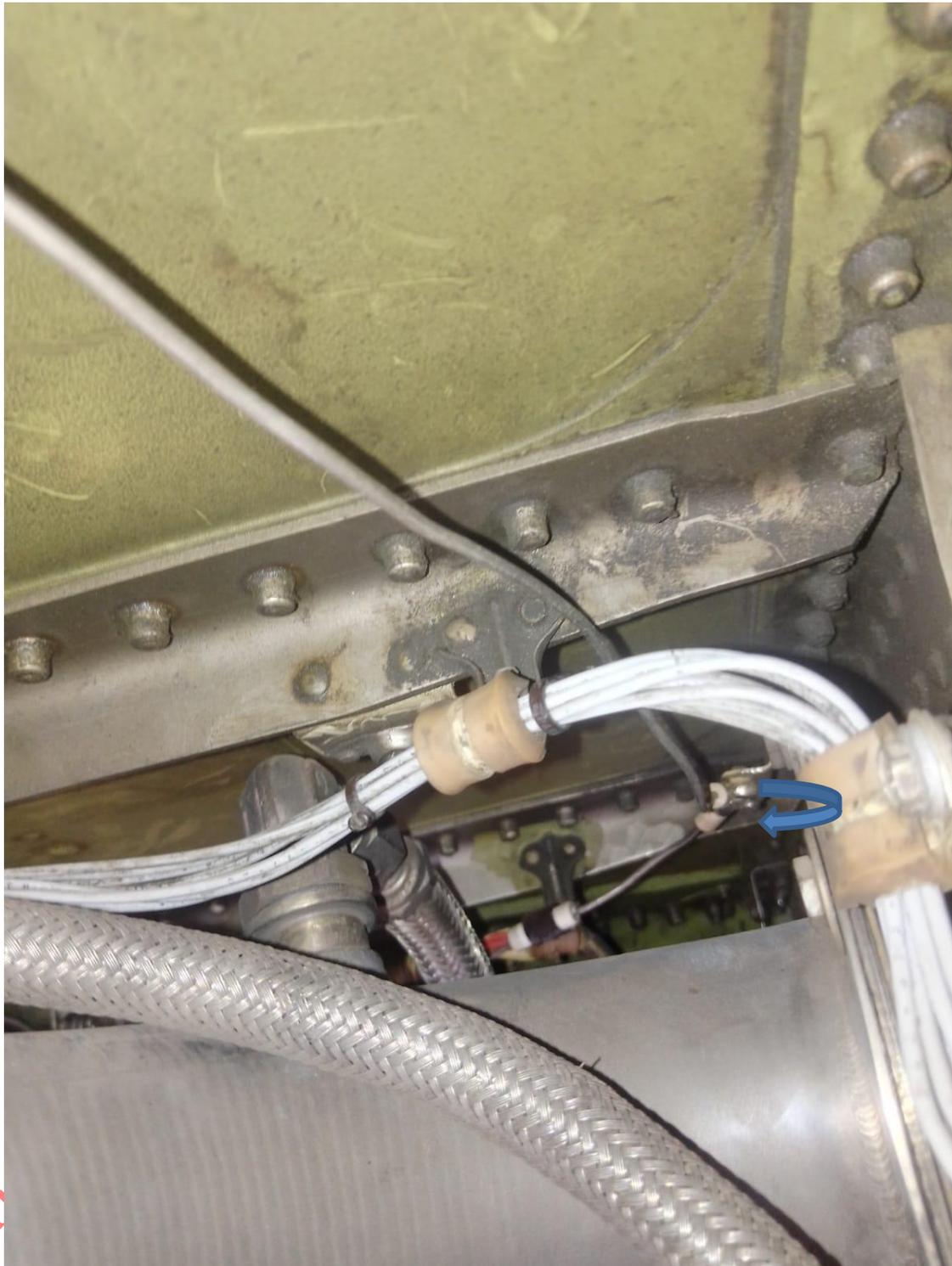
**Imagen 8:** Ajuste de Sonda HK 5239.
