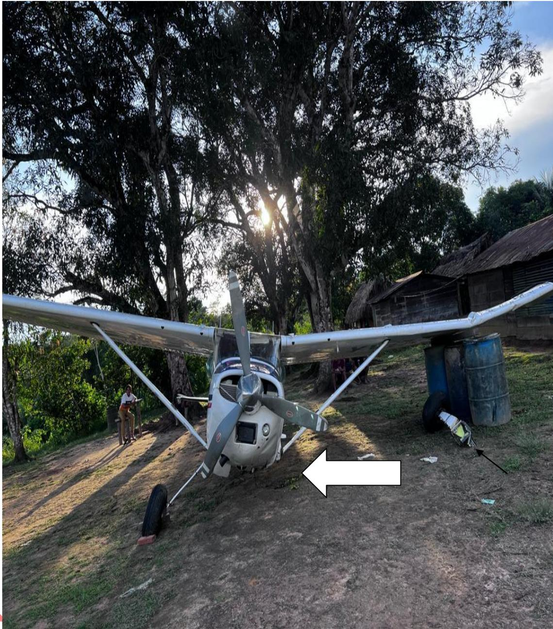
Imagen 5. Ubicación de la Aeronave fuera de la pista se puede observar la pérdida del tren principal izquierdo..
