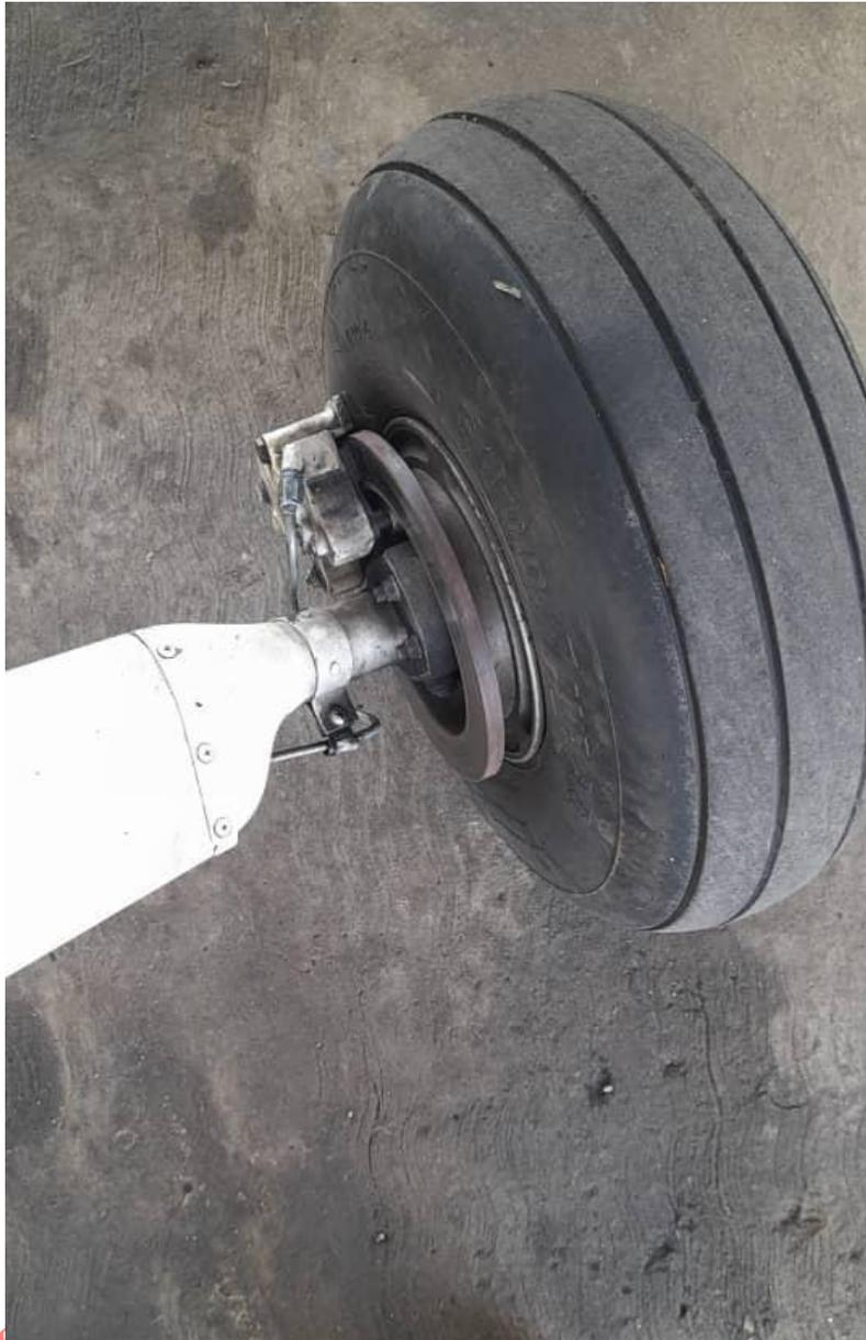
**Imagen 4:** Inspección tren principal Derecho sin fugas.
