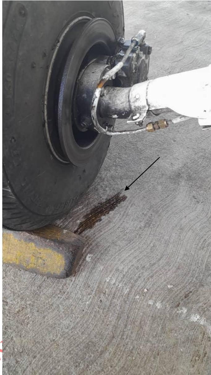
**Imagen 5:** Inspección del Tren principal izquierdo el cual presentaba fuga de fluido hidráulico.
