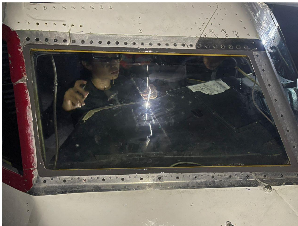
Imagen 6: Instalación de la ventana HK 5370.
