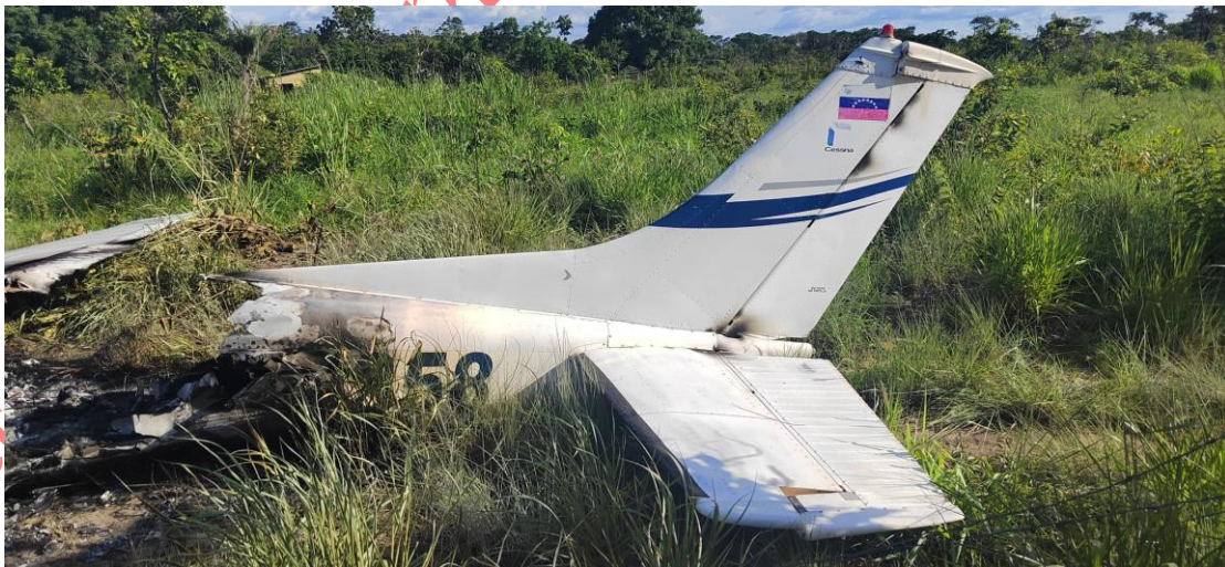
Imagen 4: Restos del YV1358 Empenaje. Fuente: Investigador Encargado Año: 2024
