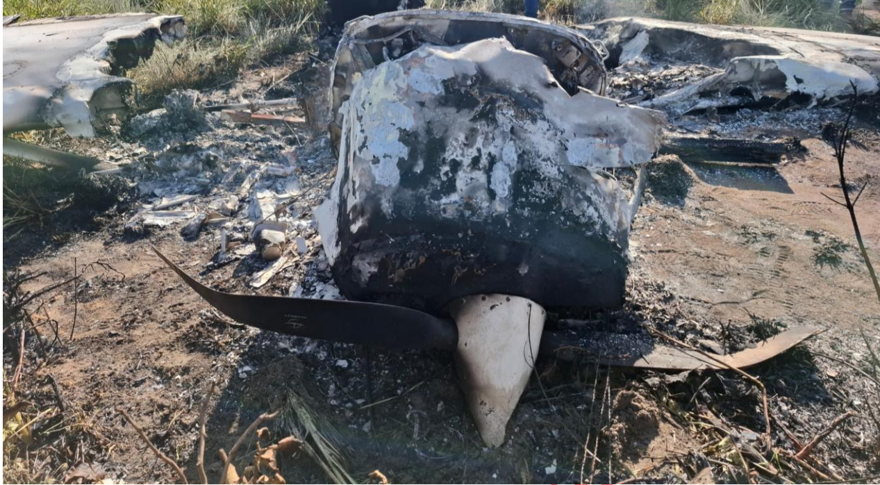
Imagen 5: Restos YV1358 Palas. Fuente: Investigador Encargado Año: 2024
