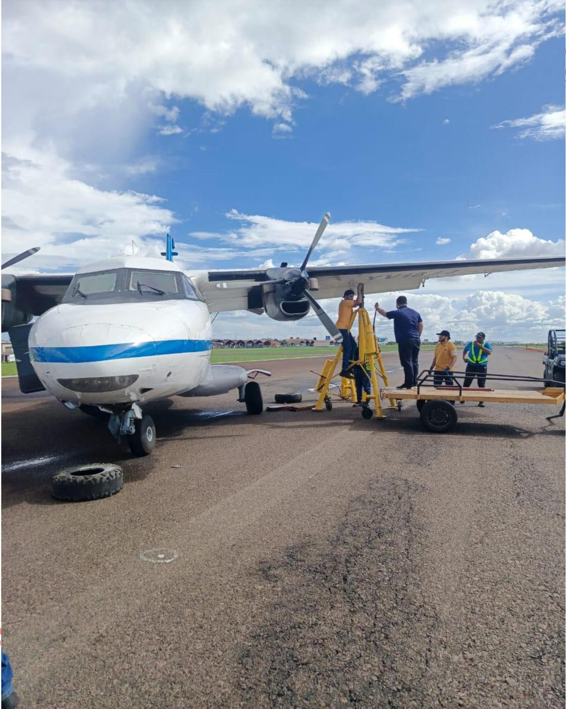
**Imagen 10:** Trabajos de extracción del tren de aterrizaje.
