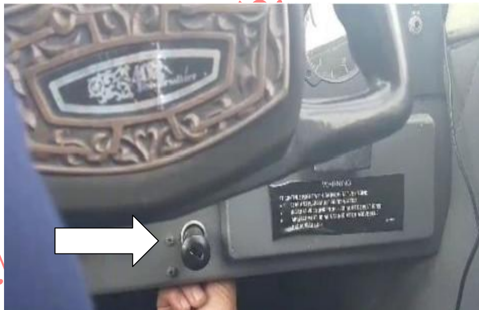
Imagen 5 Cigarrera que ocasionó el humo y el olor a quemado Por un adaptador portátil YV3105. Fuente: Investigador Encargado Año: 2024
