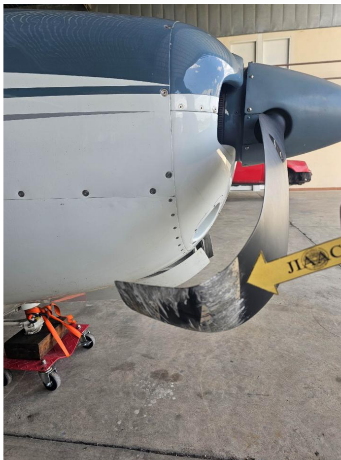
Imagen 10. Punta de palas dobladas, ocasionada por la parada brusca del motor YV1803. Fuente Investigador Encargado.
