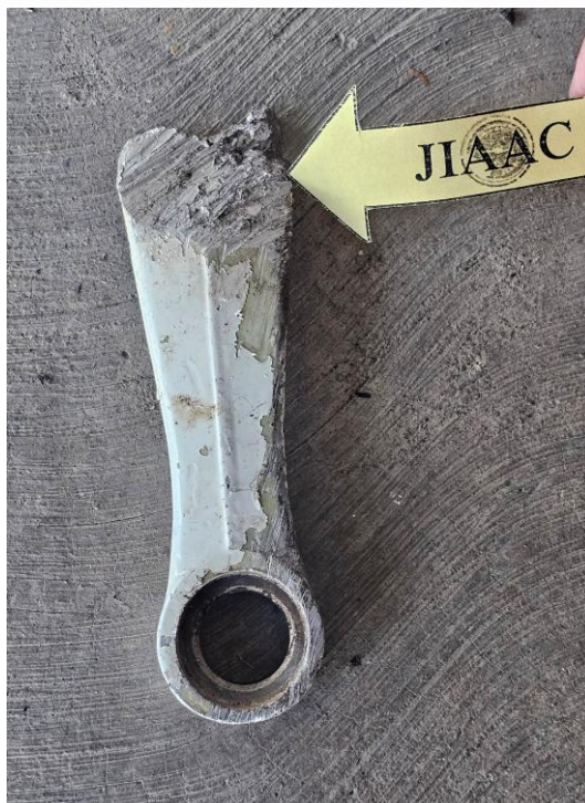
Imagen 7. Rotura por esfuerzo de tracción del Tren de nariz YV1803. Fuente: Investigador Encargado
