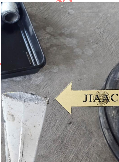
Imagen 8. Rotura por esfuerzo de tracción del Tren de nariz YV1803. Fuente: Investigador Encargado
