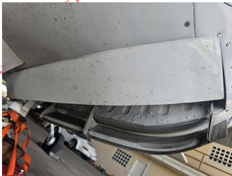
Imagen 10. Las compuertas del tren de nariz no sufrieron daños YV1803. Fuente Investigador Encargado.
