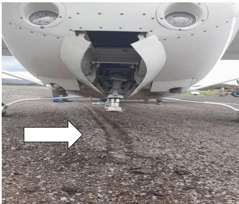
Imagen 4. Marcas sobre la pista del Tren de nariz YV1803. Fuente: Investigador Encargado
