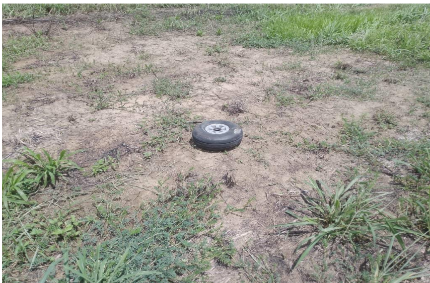
Imagen 6. Caucho del Tren de nariz encontrado en la zona de seguridad YV1803. Fuente: Investigador Encargado
