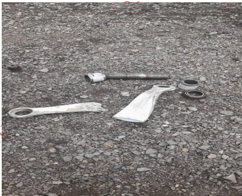
Imagen 5. Restos del Tren de nariz YV1803. Fuente: Investigador Encargado
