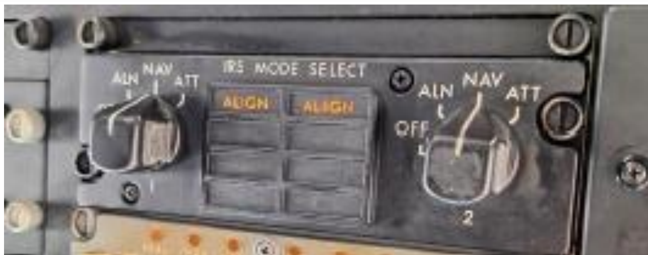
Imagen 6. Alineación de Inerciales. Fuente: Investigador Encargado
