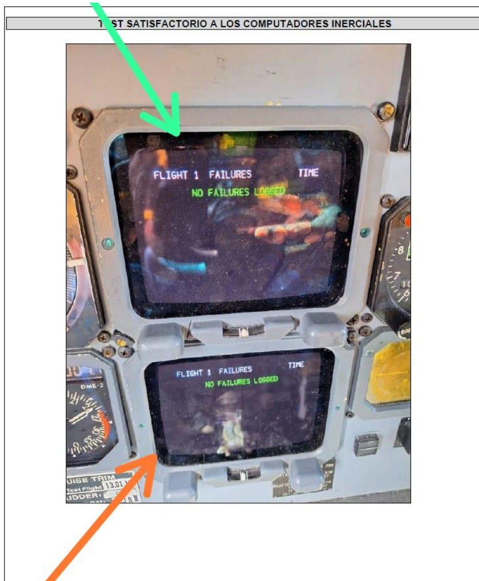
Imagen 3. Test de comprobación de las computadoras inerciales. Fuente: Investigador Encargado
