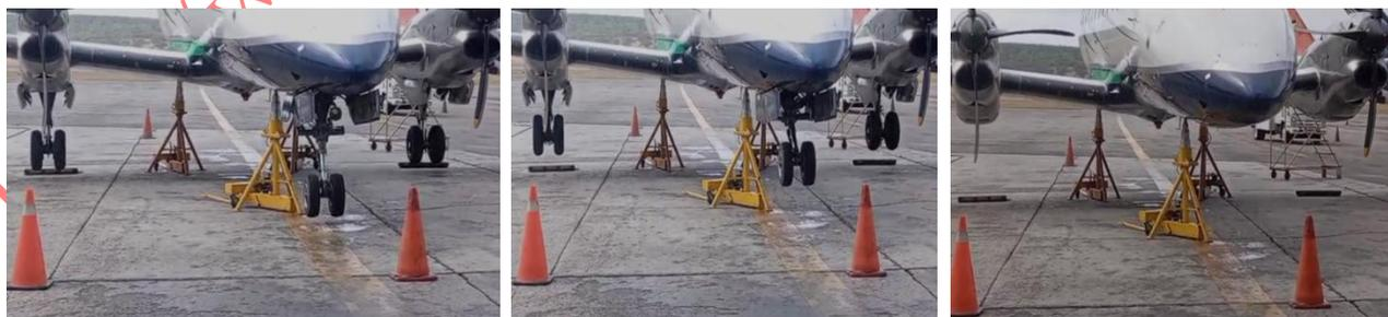
**Figura 8.** Test de Funcionamiento del Tren de Aterrizaje.
