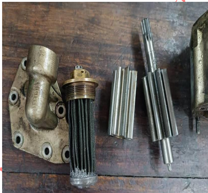
Figura 15. Evidencias de la bomba de aceite encargada de la lubricación del motor de la aeronave YV1629.
