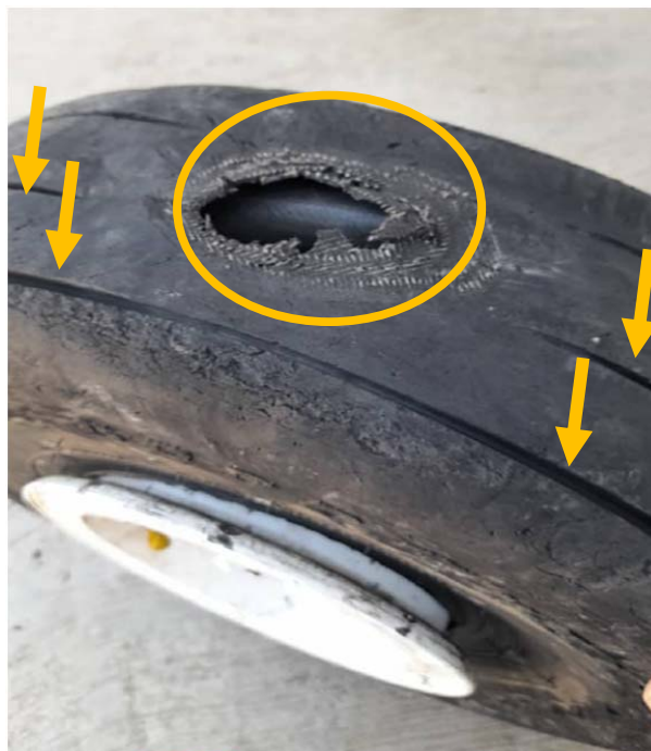
Figura 5. Comparación del daño en el material de caucho con la profundidad de la línea del neumático Fuente: Investigador Encargado. Año: 2024
