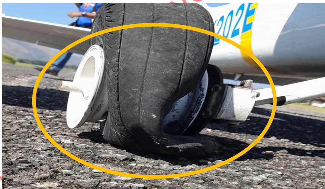
Figura 4. Evidencia del daño en el Neumático derecho del tren de aterrizaje principal. Fuente: Investigador Encargado. Año: 2024
