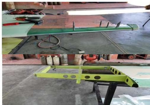
**Imagen 11, 12, 13 y 14** Proceso de remoción del empenaje de cola y reparación de los estabilizadores horizontales.
