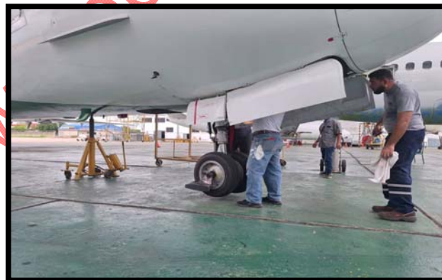
Imagen 1: Inspección del sistema de tren de nariz de la aeronave
