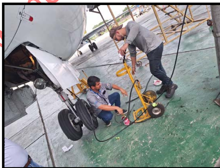
Imagen 3: Proceso de recarga de Aceite Hidráulico y Nitrógeno.
