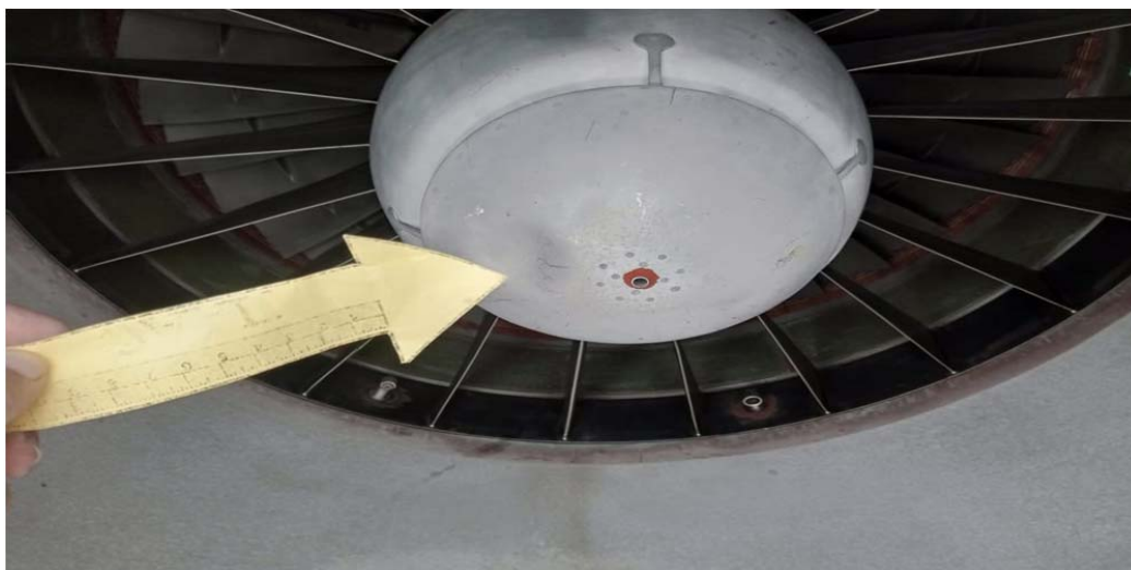
Figura 3: Golpe hallado durante la inspección del Inlet Bullet.
