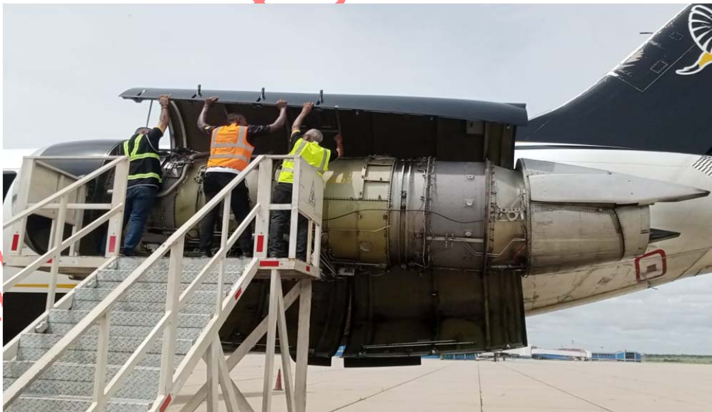
Figura 2: Inspección visual del motor izquierdo. Fuente: Investigador Encargado Año: 2023
