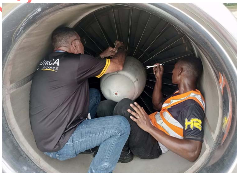
Figura 4: Remoción y cambio del Inlet Bullet
