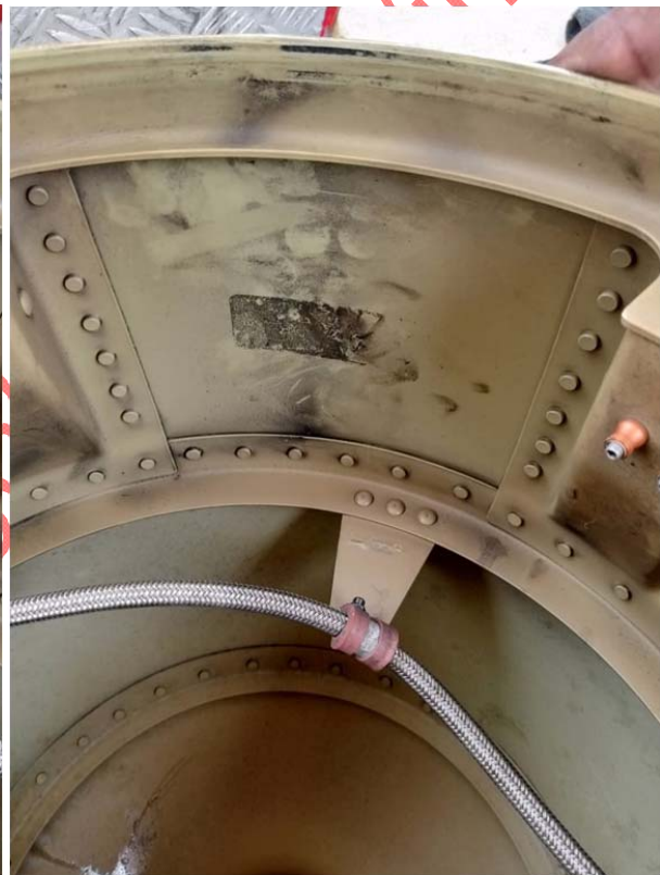
Figura 8: La sonda con desgaste dentro Inlet bullet Reemplazada.
