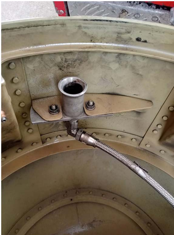
Figura 8: La sonda con desgaste dentro Inlet bullet Reemplazada.
