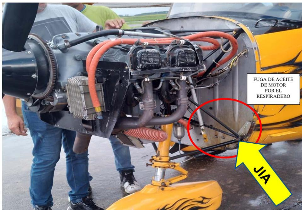
**Figura 5.** Fuga de aceite de motor por el respiradero.
