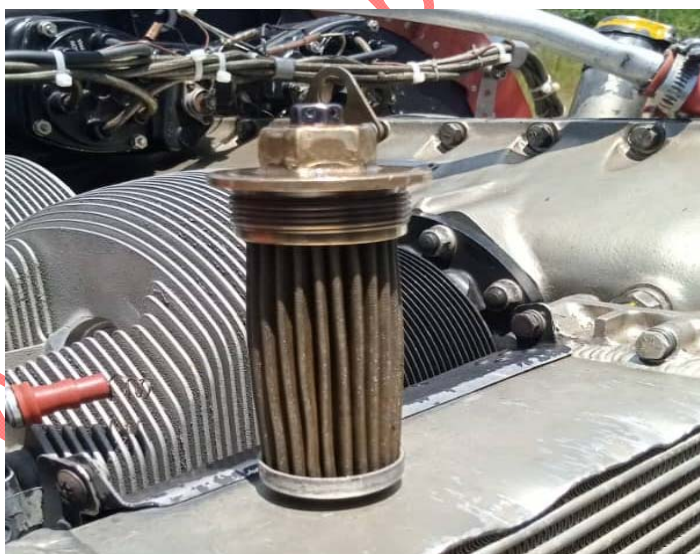
Figura 6. Chequeo De Filtro De Aceite.
