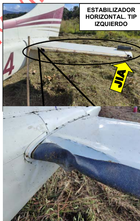
Figura 4. El Estabilizador Horizontal en ambos Tip presentaron Abolladuras y perforación.
