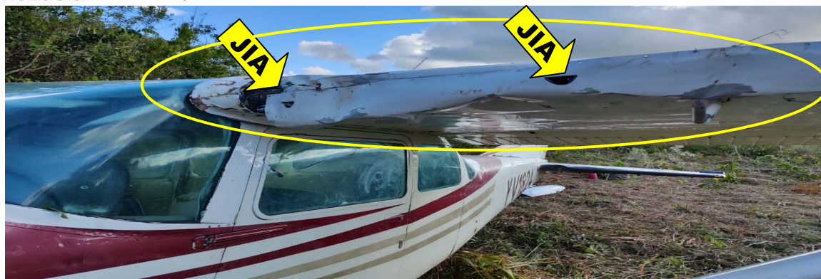
Figura 5. Daños del plano Izquierdo.
