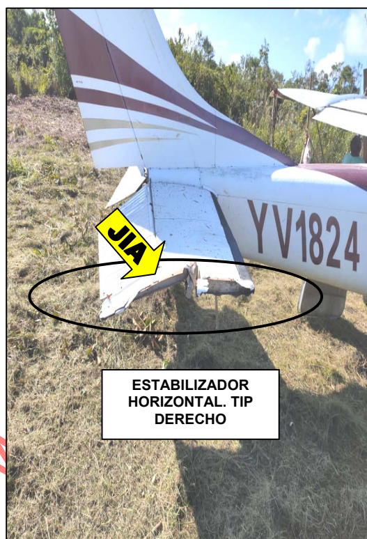
Figura 4. El Estabilizador Horizontal en ambos Tip presentaron Abolladuras y perforación.
