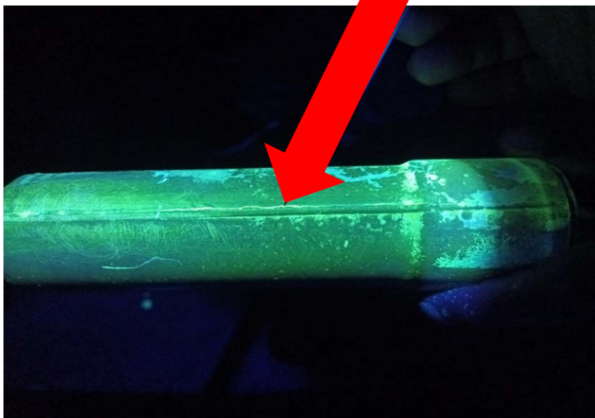
Imagen 9: Inspección NDT con líquido penetrante fluorescente en el actuador del tren principal
