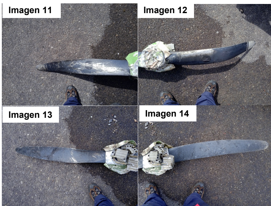
Imagen 11, 12, 13 y 14. Detalles al Daño en la Hélice
