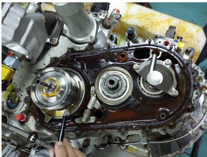
Imagen 2: Inspección de la Caja Combinadora Fuente: Investigador Encargado Año: 2021
