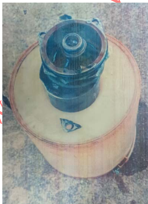
Imagen 2: Oil Filter Adapter con puntos de superior fracturados Fuente: Investigador encargado Año: 2021
