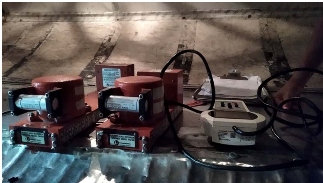
Figura 3: Remoción del Registrador de Vuelo y Grabadora de Voz de Cabina
