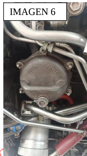
Imagen 6. Ubicación del Filtro de Combustible en el motor
