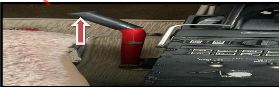
Fig.3 Palanca de Emergencia y Retracción de Trenes Hidráulico.
