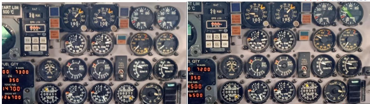
Foto 1 y 2. Corrida de potencia en tierra del motor 1 a la izquierda, corrida de potencia en tierra del motor 2 a la derecha. Ambos motores presentaron parámetros dentro de límites normales.
