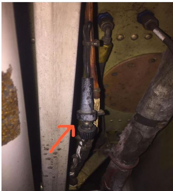
Figura 3. Fusible del Squad Switch de la pierna del tren principal izquierdo del YV2660 Fuente: Investigador Encargado. Año: 2022
