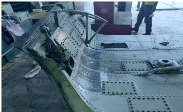
Figura 4. Compuerta reemplazada del YV480T
