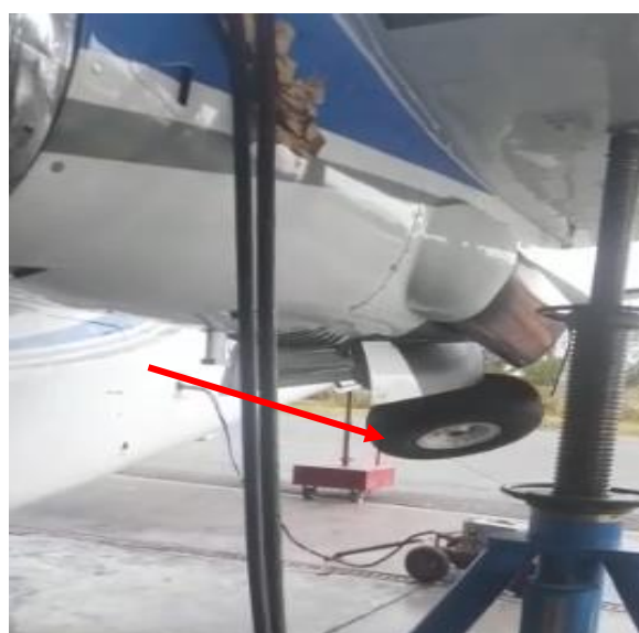
Figura 5. Retracción y extracción del tren principal izquierdo de la Aeronave YV1617.
