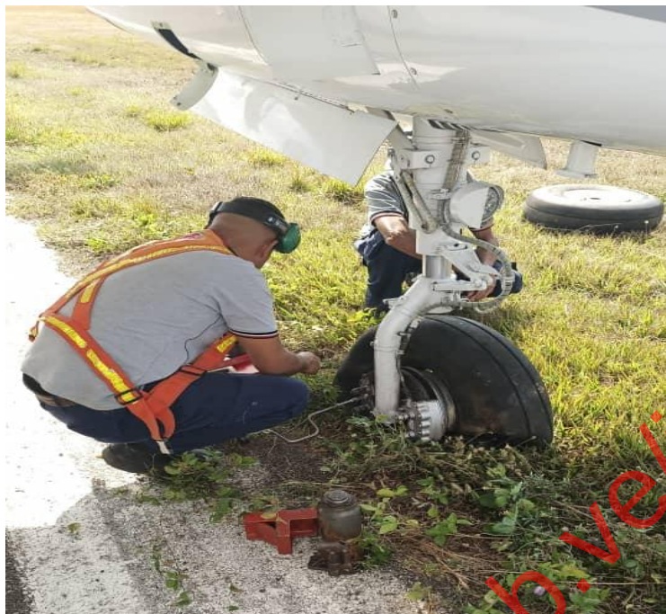
Figura 3 Ubicación del tren principal izquierdo y muestra del neumático destalonado de la Aeronave YV1617. Fuente: Investigador Encargado. Año: 2023
