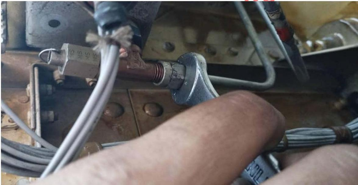
Fotografía 3. Instalación de la T y ajuste del conector de la línea PT7 para una medición exacta del instrumento de indicador de la relación de presión del motor, con su nombre en inglés Indicator Engine Pressure Ratio (EPR) del motor 1.
